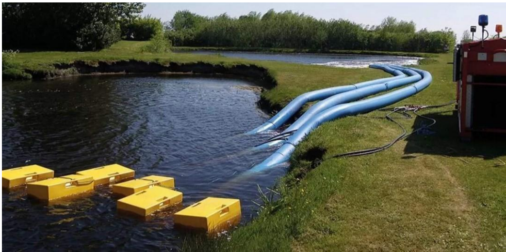
Slika 21: Hytrans FloodModule kao obrana od poplava [18]
