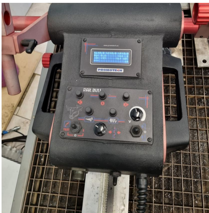
Slika 6.4. Uređaj za automatizirano zavarivanje – RAIL BULL [27]
