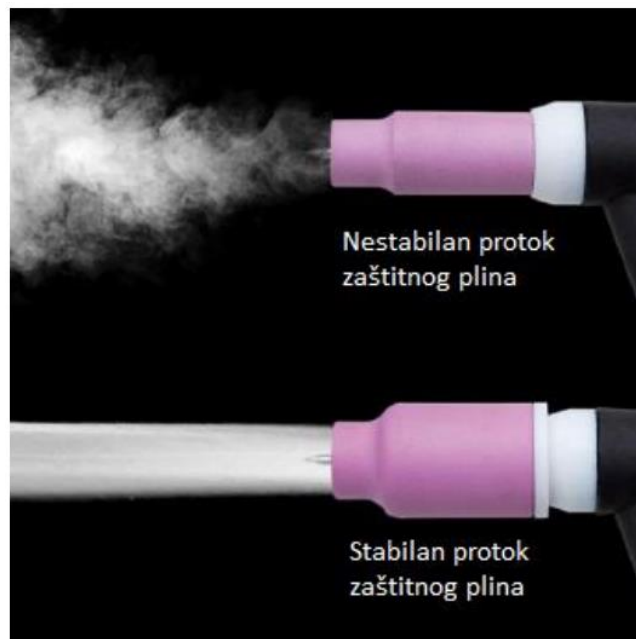
Slika 5.11. Stabilan i nestabilan protok zaštitnog plina [23]
