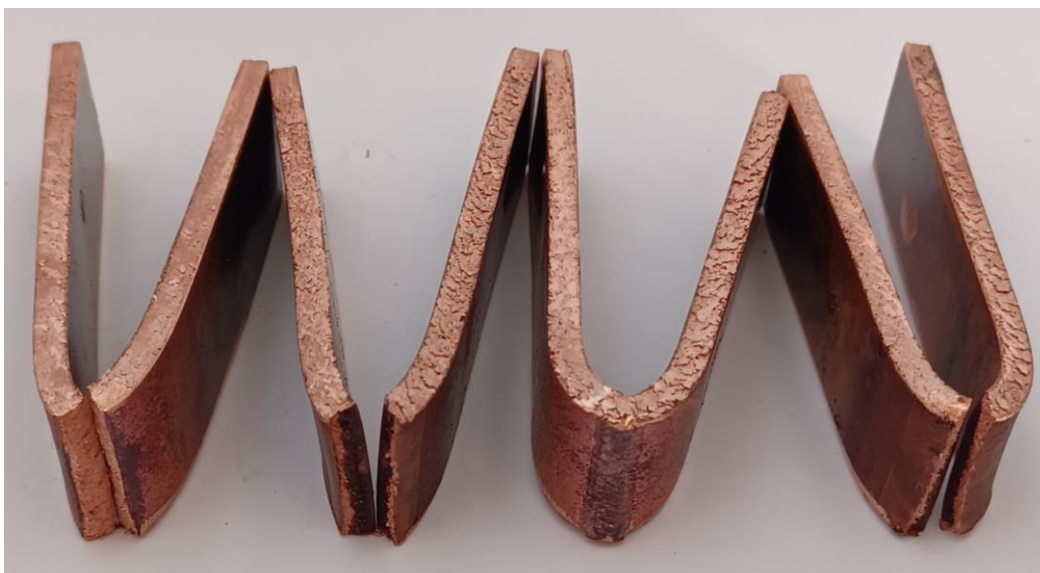
Slika 6.13. Rezultat savijanja uzorka 8 [27]
