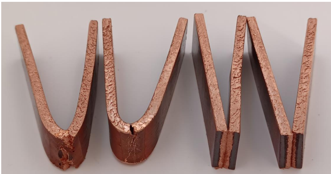
Slika 6.12. Rezultat savijanja uzorka 7 [27]
