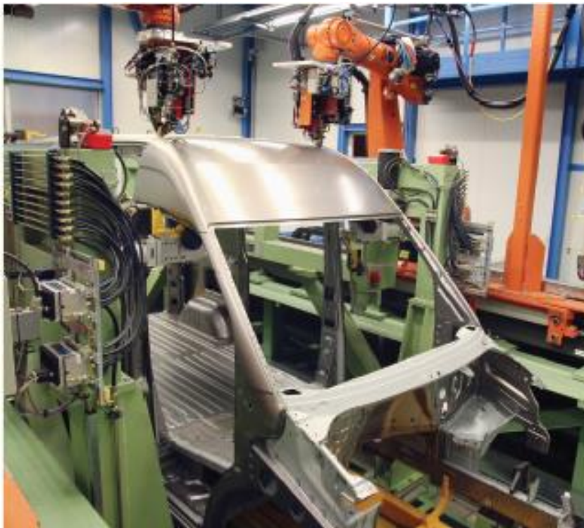
Slika 4.7 Robotizirano lasersko zavarivanje krova u Daimler tvornici. [17]
