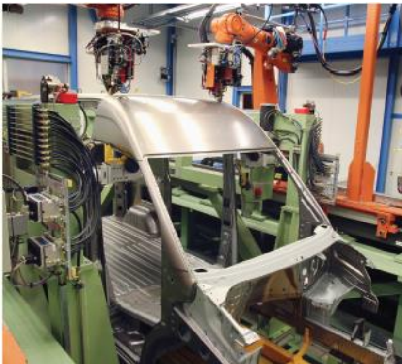
Slika 4.7 Robotizirano lasersko zavarivanje krova u Daimler tvornici. [17]
