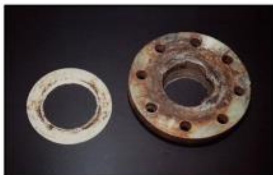
Slika 5.1.2.2 Primjer oštećenja uzrokovana korozijom u procjepu [30]
