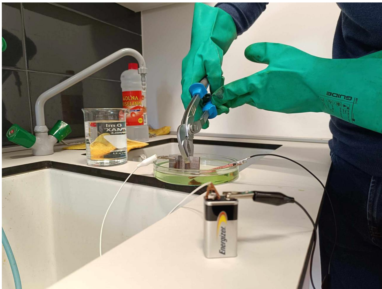
Slika 6.8.5. Elektrokemijsko nagrivanje uzorka
