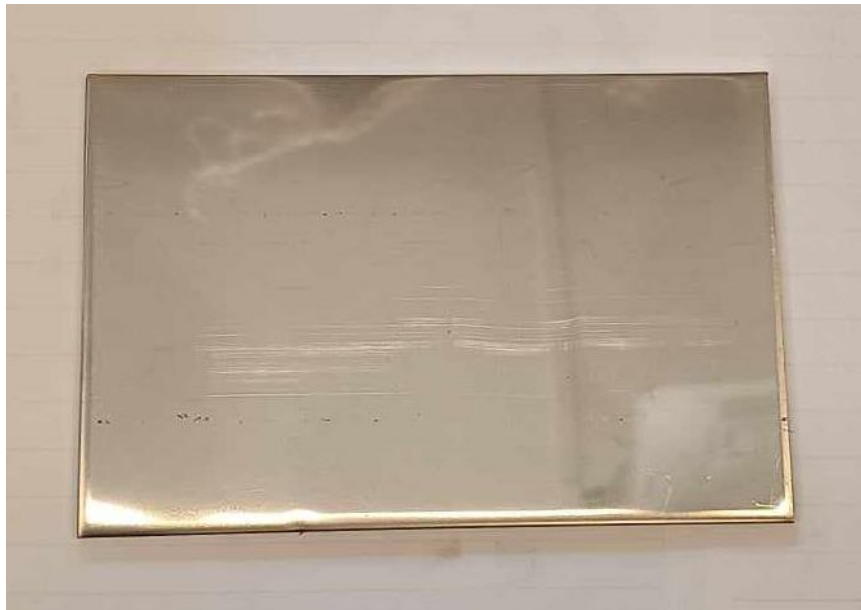
Slika 6.2.1. Pločica AISI 304 dimenzija 200 mm × 80 mm × 3 mm
