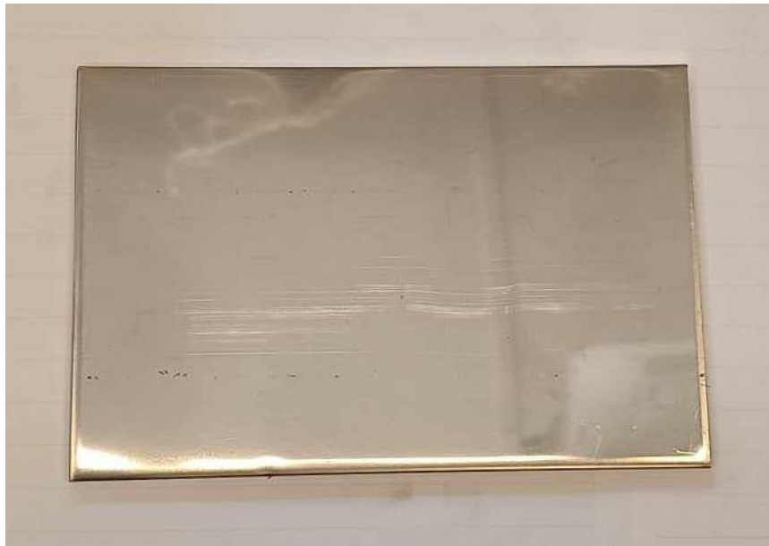
Slika 6.2.1. Pločica AISI 304 dimenzija 200 mm × 80 mm × 3 mm
