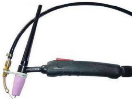
Slika 2.5.2.1. Pištolj za poluautomatizirano TIG zavarivanje [12]
