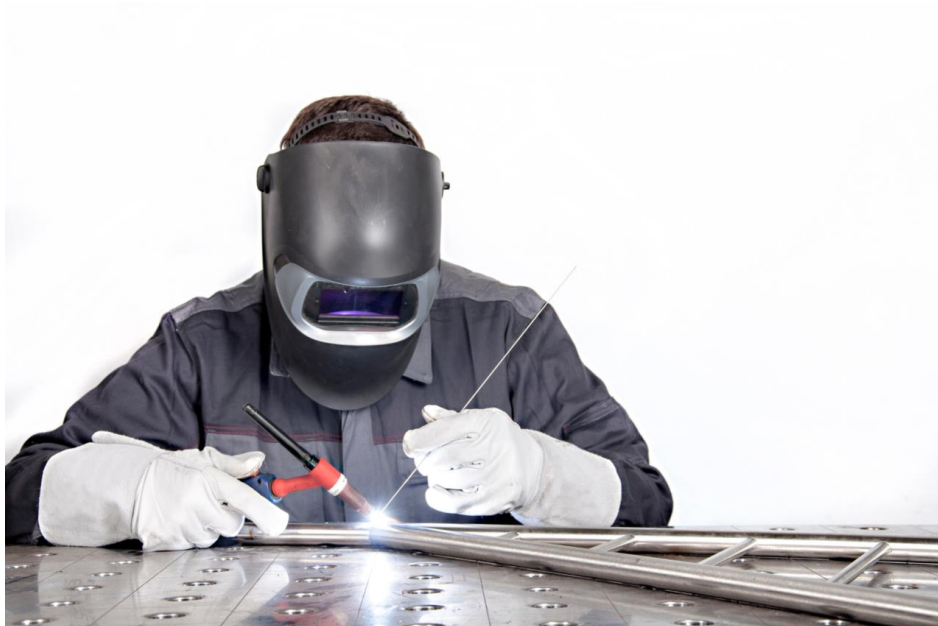
Slika 2.2.1 Ručno TIG zavarivanje [7]
