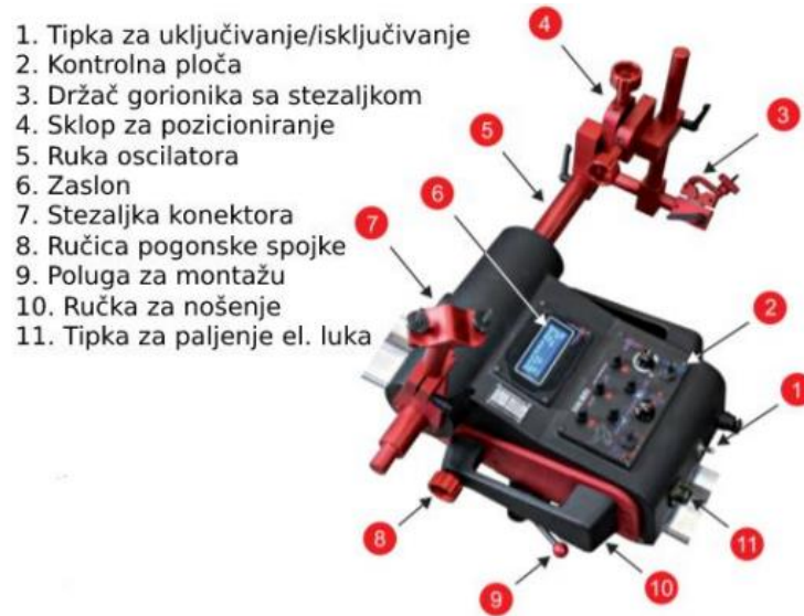
Slika 6.5.1. Dijelovi Rail Bull automata [38]
