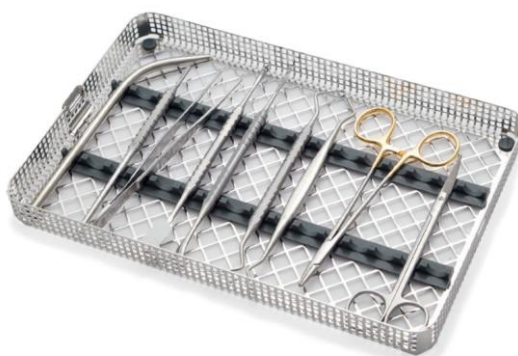
Slika 4.1.2.1 Primjer upotrebe martenzitnog nehrđajućeg čelika
