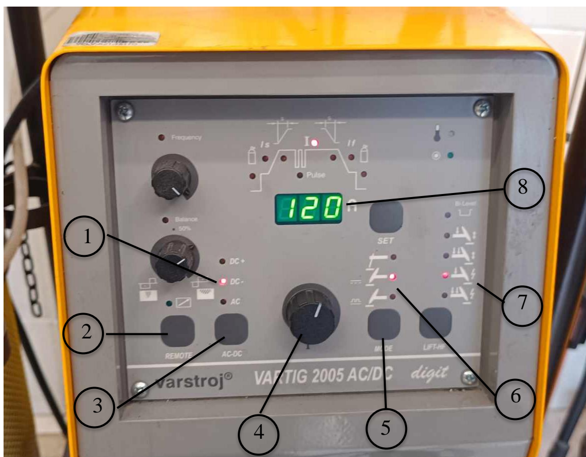
Slika 6.4.1. Kontrolna ploča sa funkcijama
