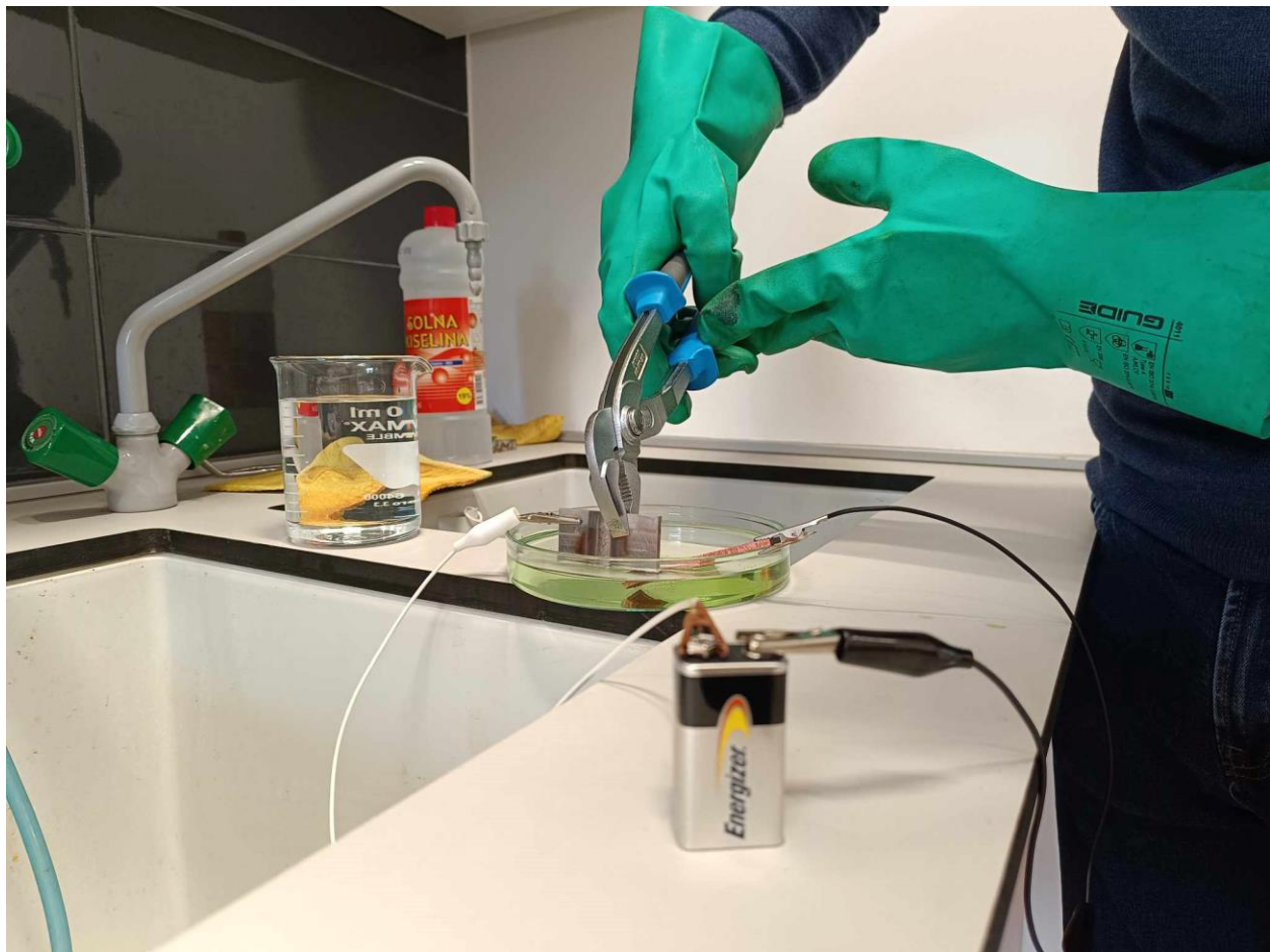
Slika 6.8.5. Elektrokemijsko nagrivanje uzorka
