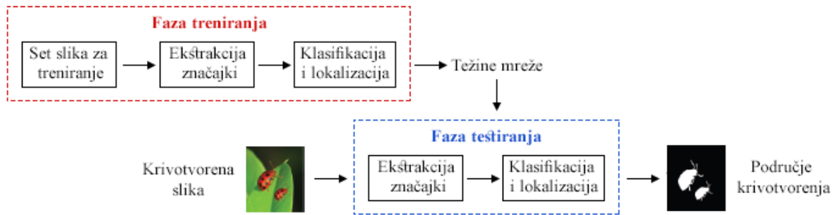
Slika 4.1: Osnovni okvir za otkrivanje krivotvorenja na slikama temeljen na dubokom učenju.
