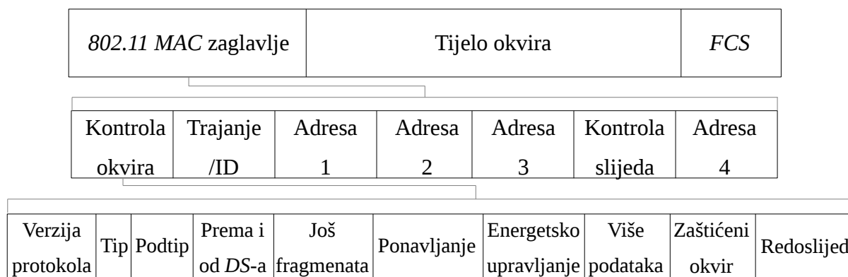
Slika 2.3. Struktura IEEE 802.11 okvira
