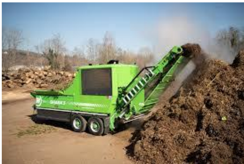
Slika 13. Stroj za usitnjavanje mase za kompost
