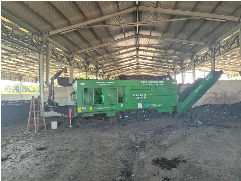
Slika 24. Stroj za prosijavanje kompostnih hrpa
