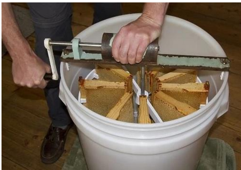
Slika 2.3. Vrcanje meda ručnom vrcaljkom [15]
