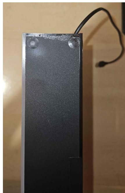
Slika 9.2.10 Donji dio instalacije sa ublaživačima
