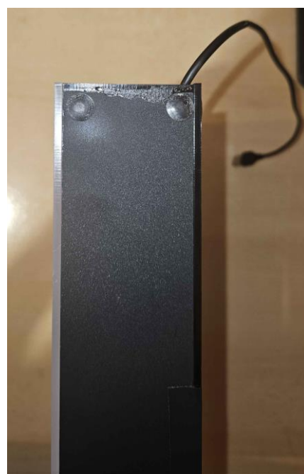
Slika 9.2.10 Donji dio instalacije sa ublaživačima
