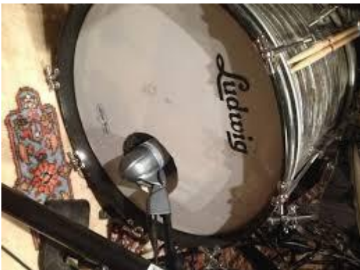
Slika 3.7: Pozicija mikrofona za kick
