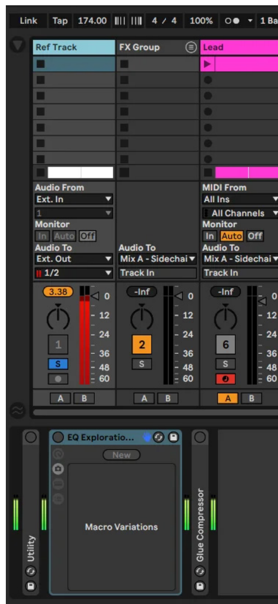
Slika 5 zvuk „ulazi u crveno” što ukazuje na pojavu distorzije
