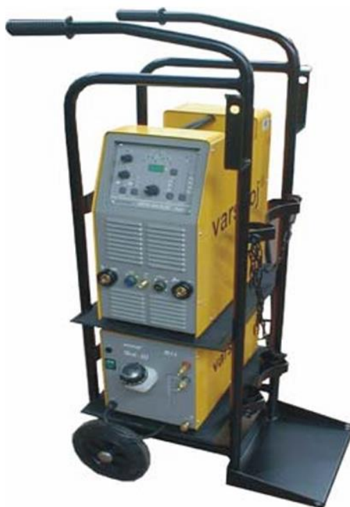
Slika 58 Uređaj za TIG zavarivanje, Vartig 2005 AC/DC [18].
