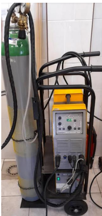
Slika 58 Uređaj za TIG zavarivanje, Vartig 2005 AC/DC [18].
