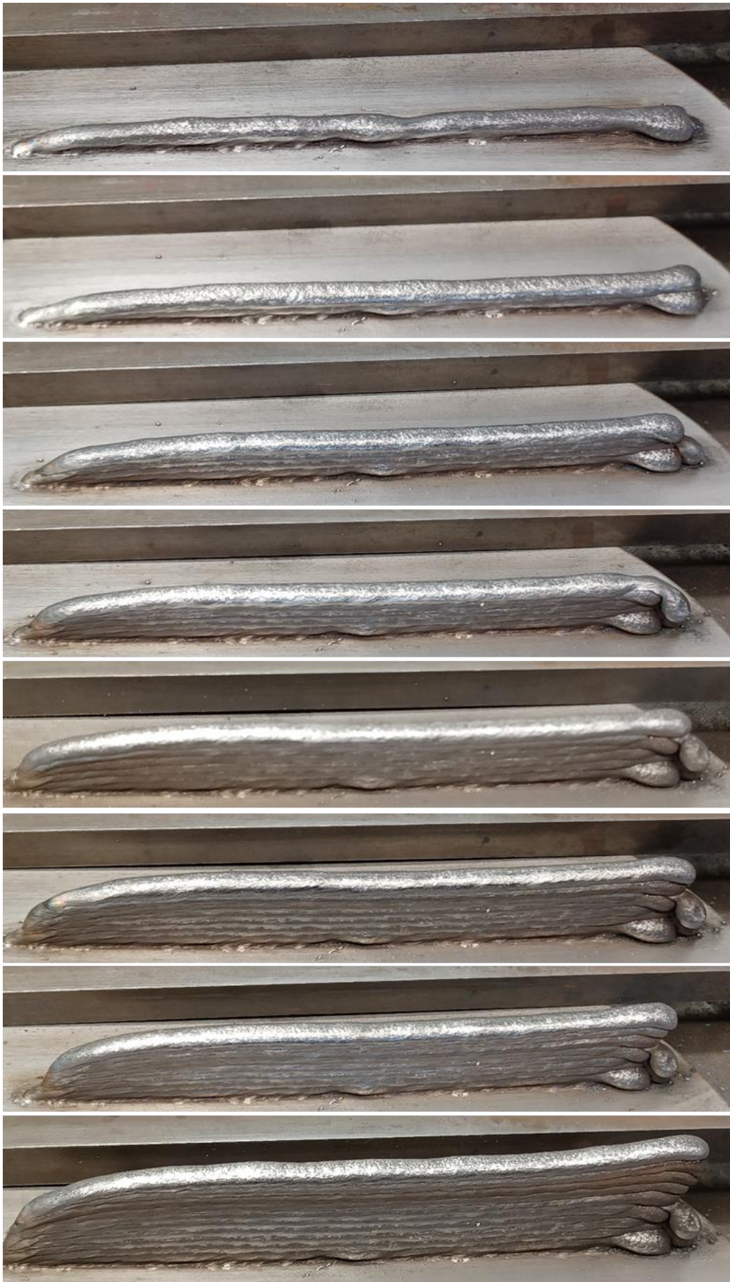
Slika 32: Proces navarivanja Zida 2 sloj po sloj
