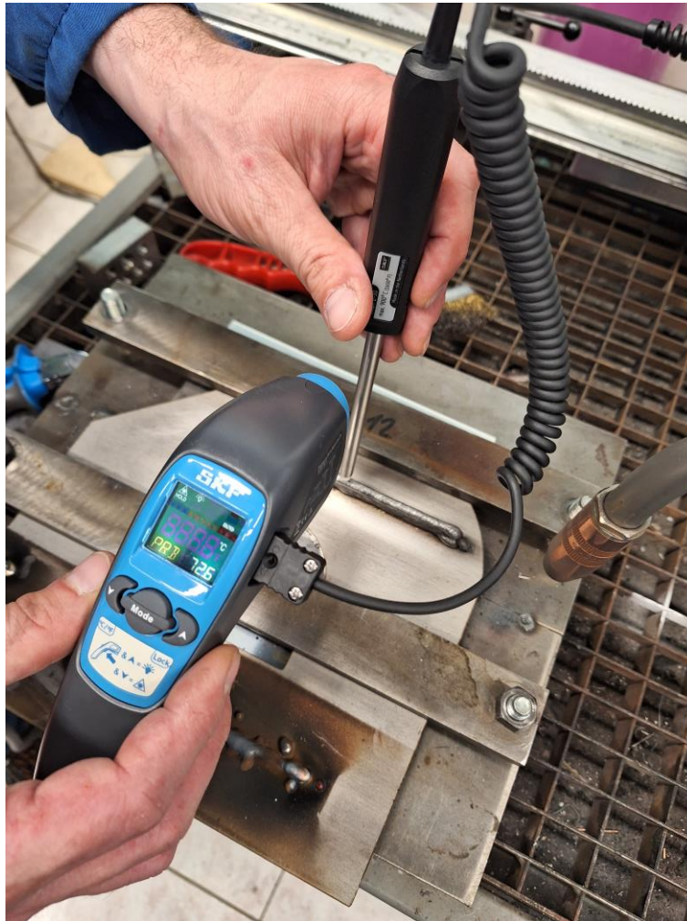
Slika 30: Mjerenje temperature navarenog sloja
