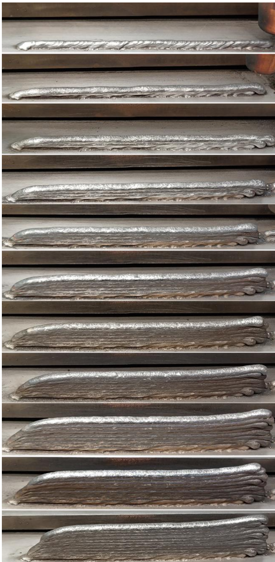
Slika 31: Proces navarivanja Zida 1 sloj po sloj
