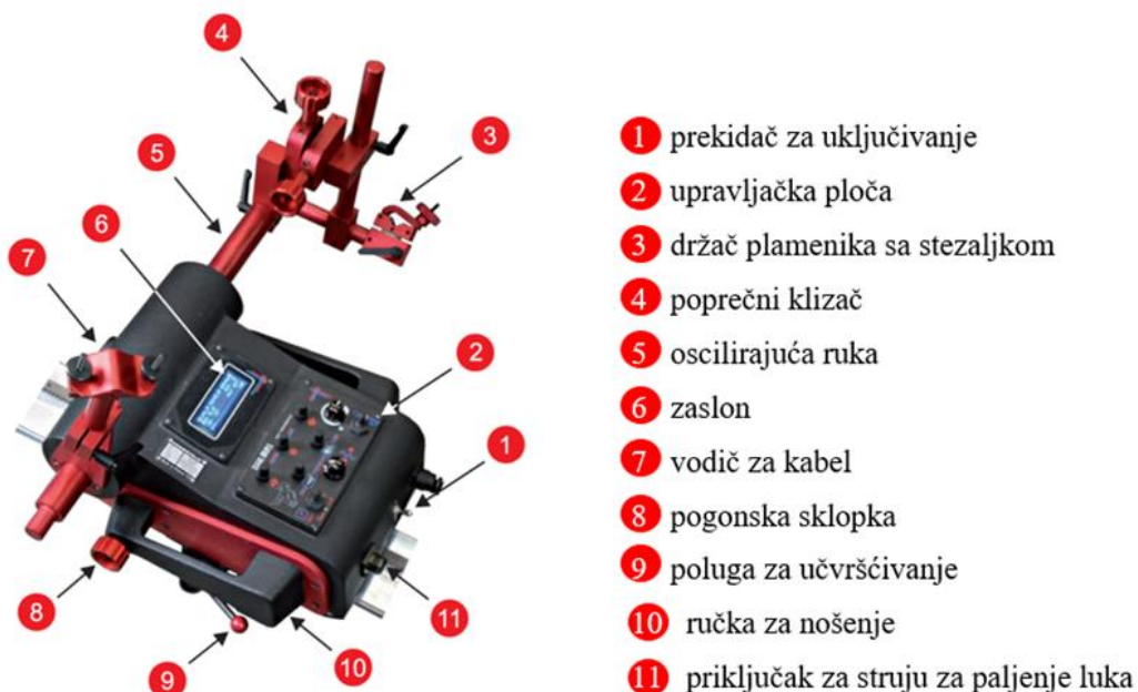
Slika 27: Uređaj za vođenje gorionika tijekom zavarivanja [34]
