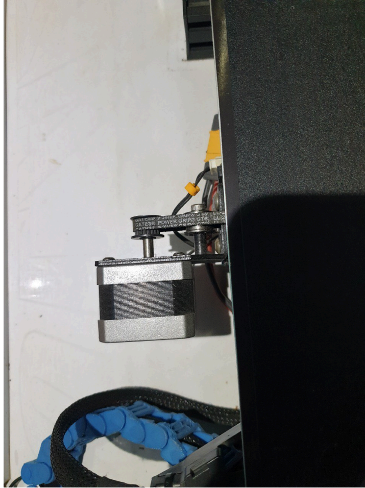
Slika 19. Motor koji pokreće os y (autorski rad)
