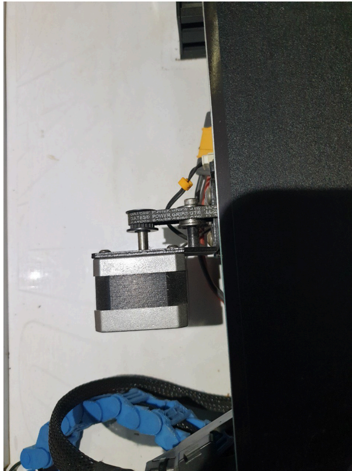
Slika 19. Motor koji pokreće os y (autorski rad)
