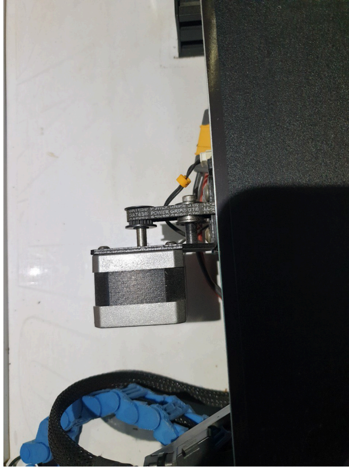
Slika 19. Motor koji pokreće os y (autorski rad)
