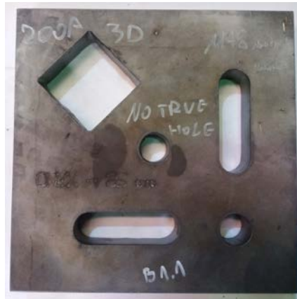
Slika 4.3.46. Uzorak B9.1 debljine 25 mm s podacima o rezanju
