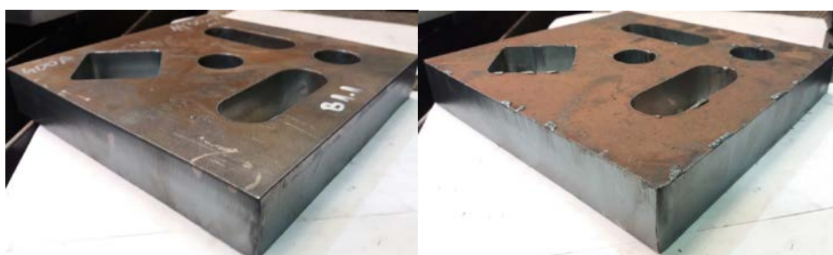
Slika 4.3.57. Uzorak B11.1 debljine 35 mm slikan s gornje i donje strane
