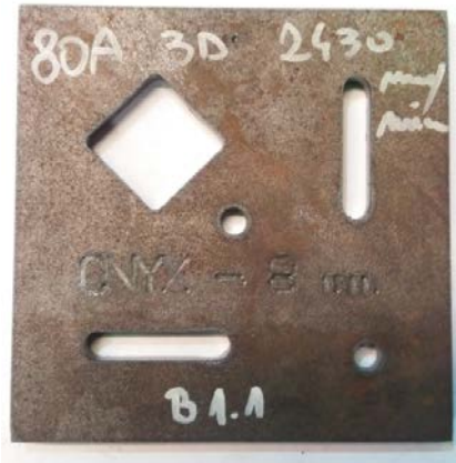
Slika 4.3.24. Uzorak B5.1 debljine 8 mm s podacima o rezanju
