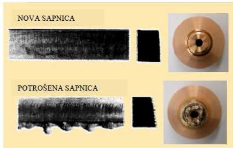
Slika 3.5. b) Učinak istrošenosti sapnice na površinu koja se reže te na pojavu srha [2]
