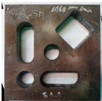
Slika 4.3.58. Uzorak B12.1 debljine 40 mm s podacima o rezanju
