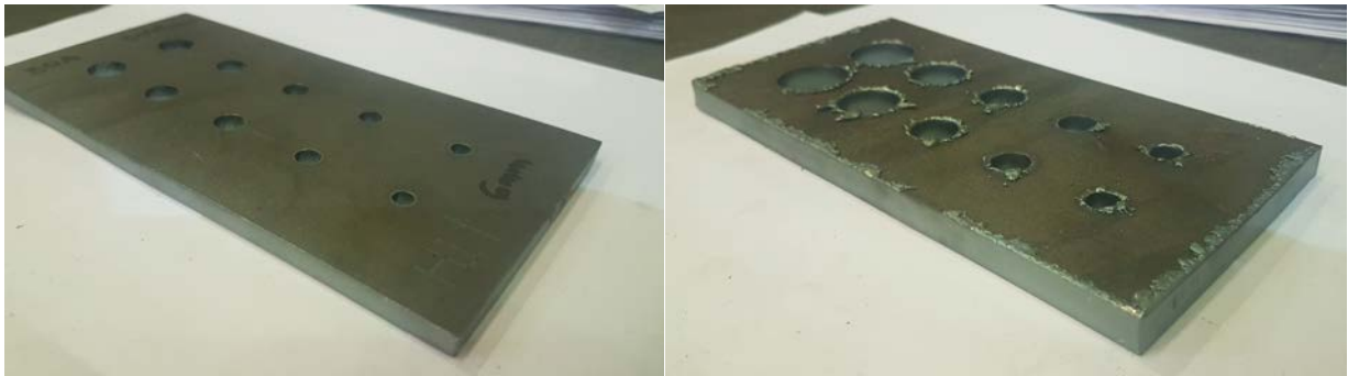
Slika 4.3.62. Uzorak C1.1 debljine 6 mm slikan s gornje i donje strane
