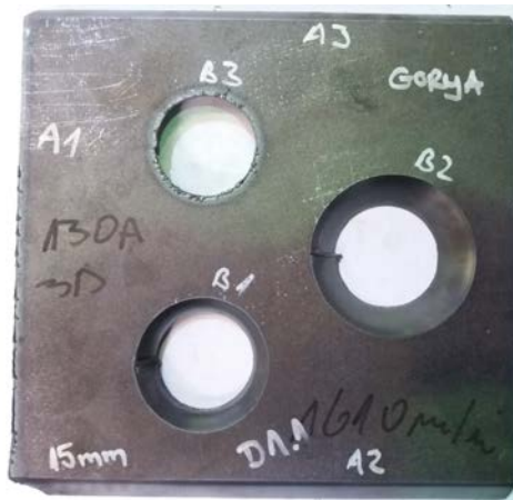
Slika 4.3.68. Uzorak D2.1 debljine 15 mm s podacima o rezanju i oznakama
