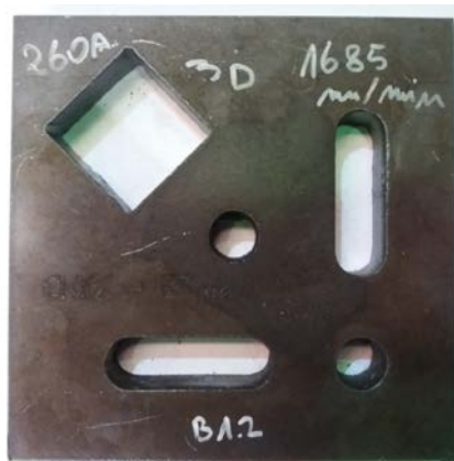
Slika 4.3.48. Uzorak B9.2 debljine 25 mm s podacima o rezanju
