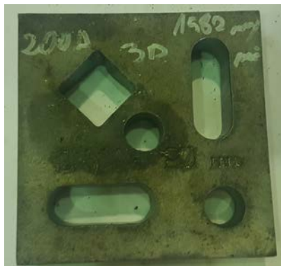
Slika 4.3.40. Uzorak B8.2 debljine 20 mm s podacima o rezanju
