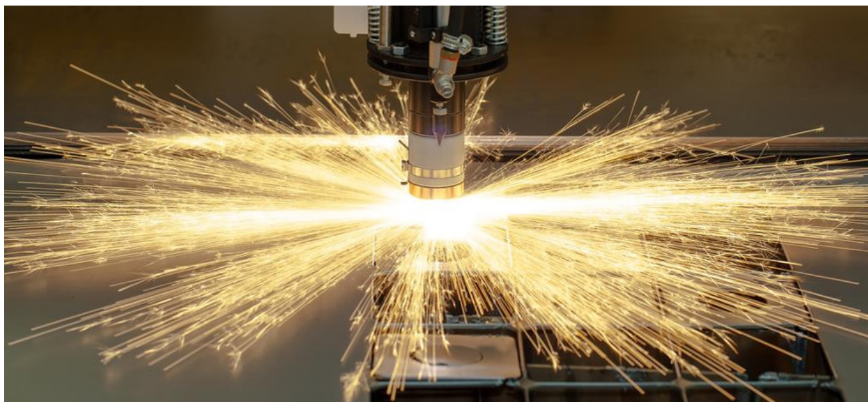
Slika 3.2. CNC plazma rezanje [5]
