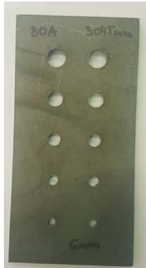
Slika 4.3.61. Uzorak C1.1 debljine 6 mm s podacima o rezanju
