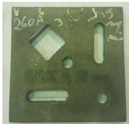
Slika 4.3.36. Uzorak B7.3 debljine 12 mm s podacima o rezanju
