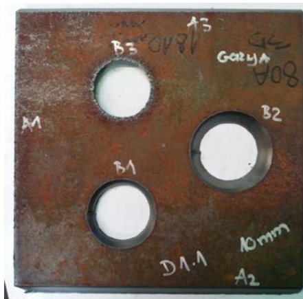
Slika 4.3.66. Uzorak D1.1 debljine 10 mm s podacima o rezanju i oznakama
