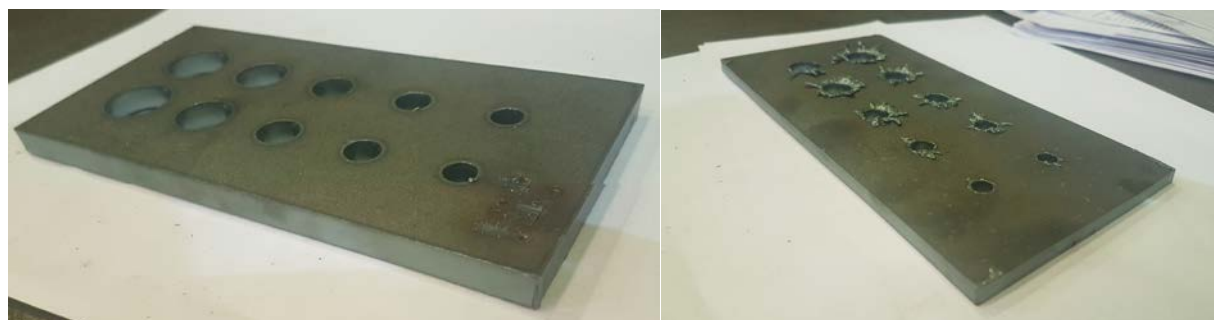
Slika 4.3.65. Uzorak C2.1 debljine 10 mm slikan s gornje i donje strane
