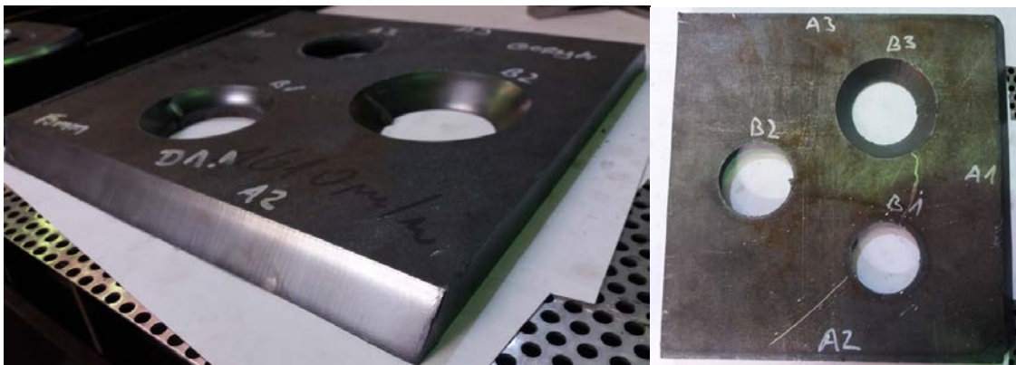
Slika 4.3.69. Uzorak D2.1 debljine 15 mm slikan s gornje i donje strane s oznakama
