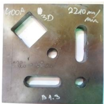
Slika 4.3.50. Uzorak B9.3 debljine 25 mm s podacima o rezanju
