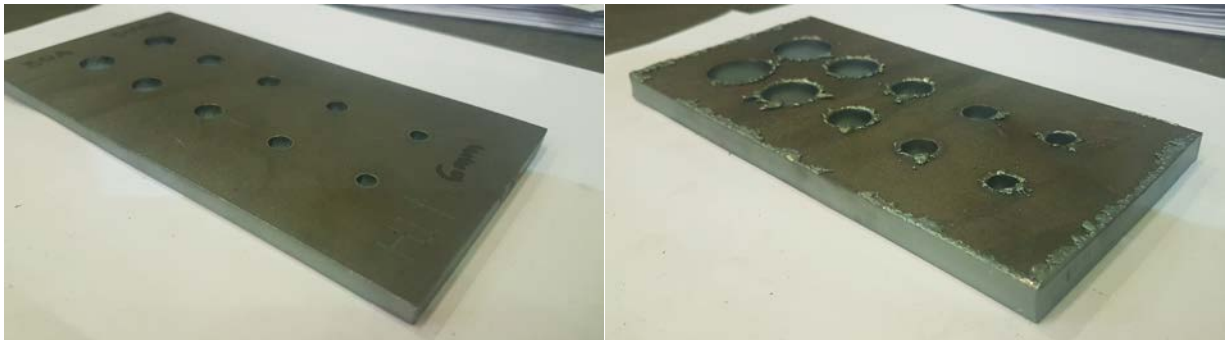
Slika 4.3.62. Uzorak C1.1 debljine 6 mm slika s gornje i donje strane
