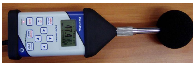
Slika 7.1 Zvukomjer Svantek, Svan 945A
