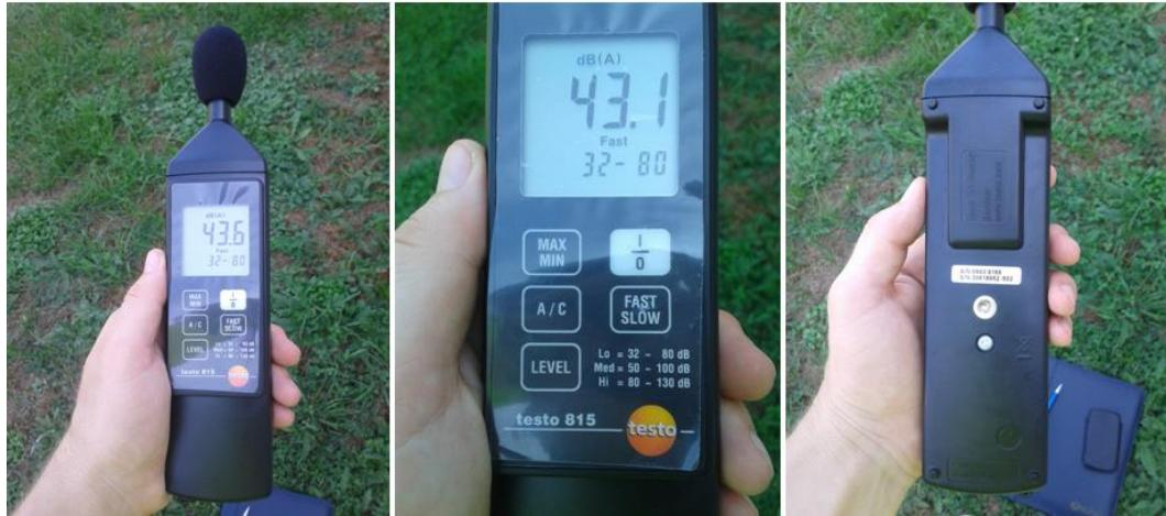
Slika 7.3 Zvukomjer Testo 815
