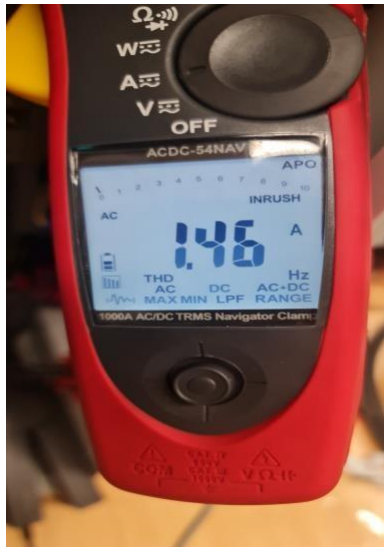
Slika 6.4 – Mjerenje strujnim kliještima kod pokretanja VFD-om
