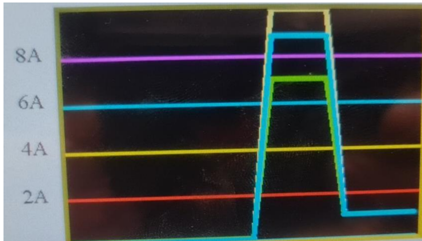
Slika 6.10 – Mjerenje PLC-om kod pokretanja Soft-starterom na tri faze
