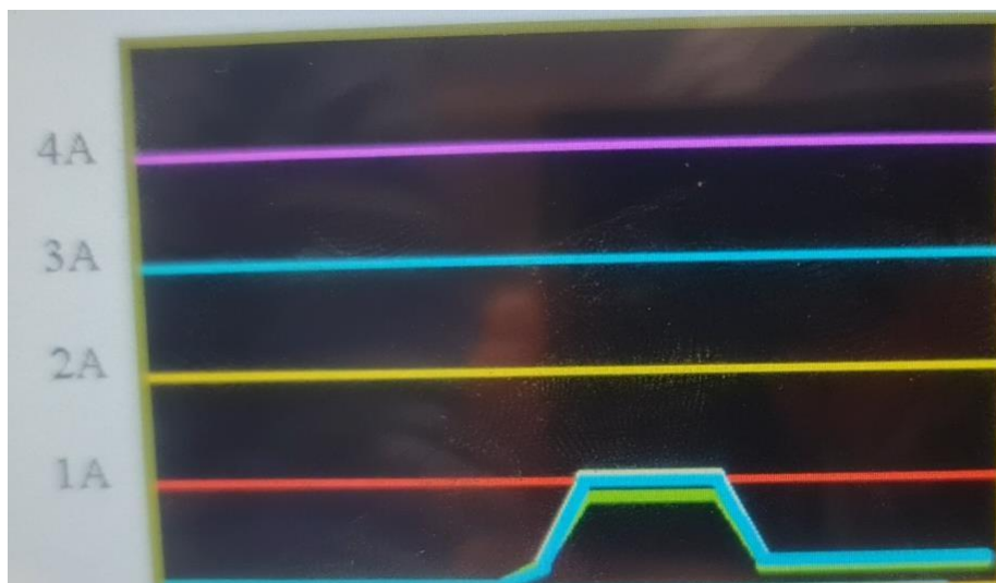
Slika 6.3 – Mjerenje PLC-om kod pokretanja VFD-om
