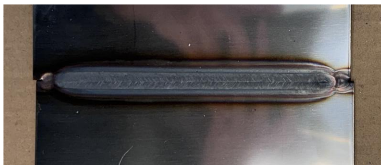
Slika 28. Lice zavara uzorka 1
