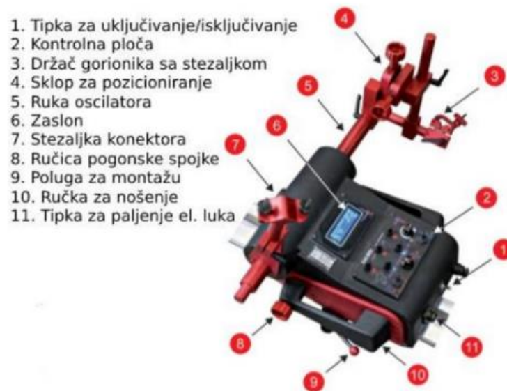
Slika 27. Dijelovi uređaja Rail Bull Promotech [35]
