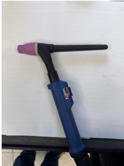
Slika 22. Pištolj za TIG zavarivanje
