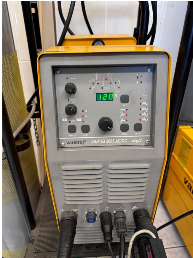
Slika 20. Izvor struje - uređaj VARTIG 2005 AC/DC
