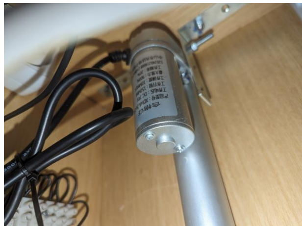
Slika 3.4. Motor montirani na kutnike
