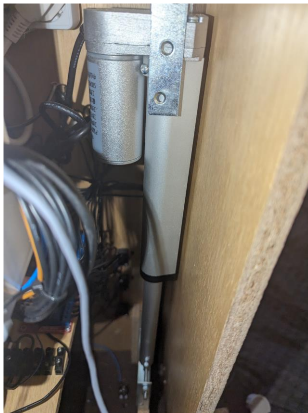
Slika 4.1. Linearni aktuator – izvučeni položaj
