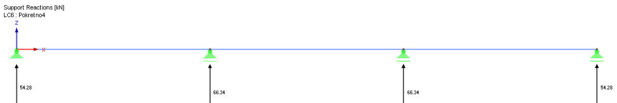
Slika 76 Reakcije oslonca [kN]
