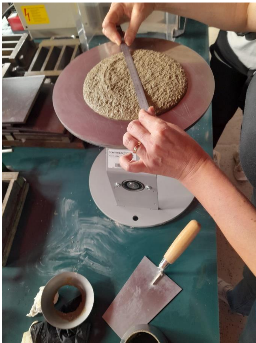
Slika 49. Određivanje konzistencije morta na stoliću za potresanje
