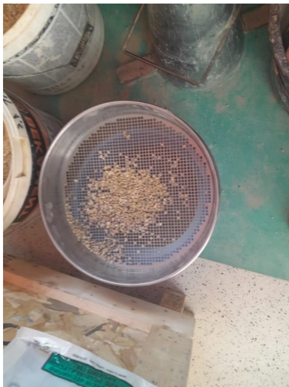
Slika 44. Ostaci agregata ( pijeska ) na situ
