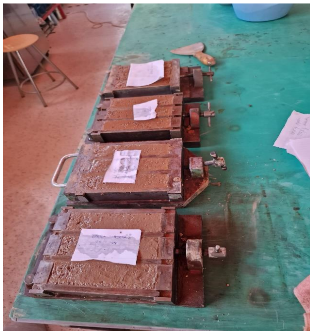
Slika 51. Mješavine morta ugrađene u kalupe
