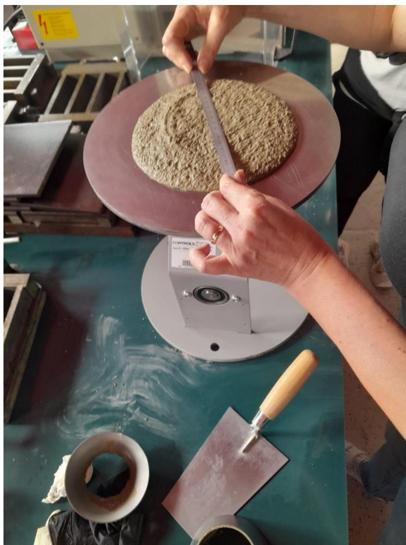
Slika 49. Određivanje konzistencije morta na stoliću za potresanje
