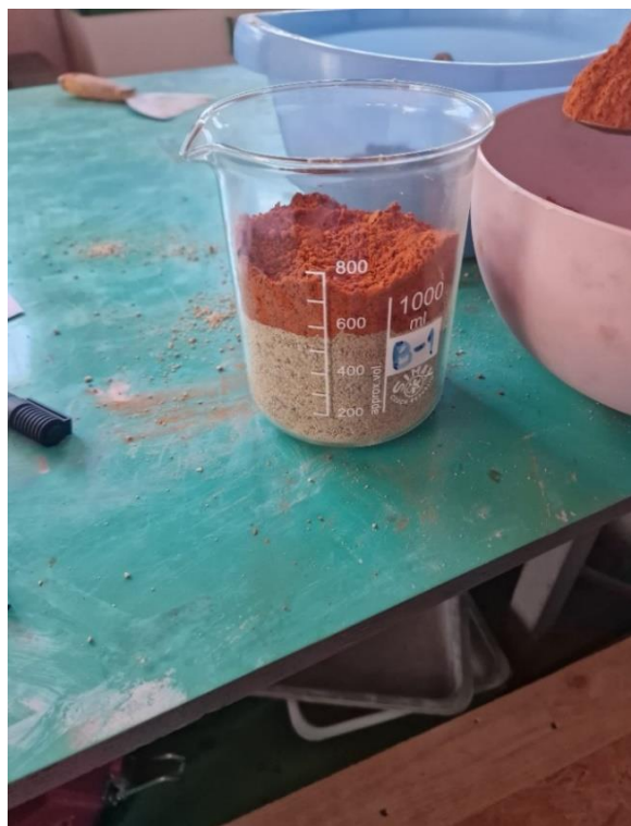
Slika 45. Prosijani agregat ( pijesak i drobljena opeka )
