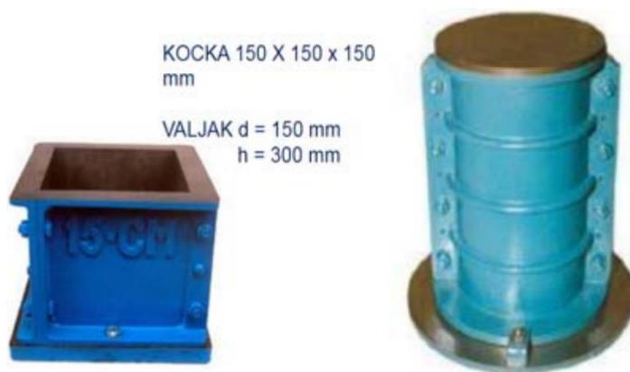
Slika 15. Izgled kalupa za pripremu uzoraka kocka i valjak [7]
