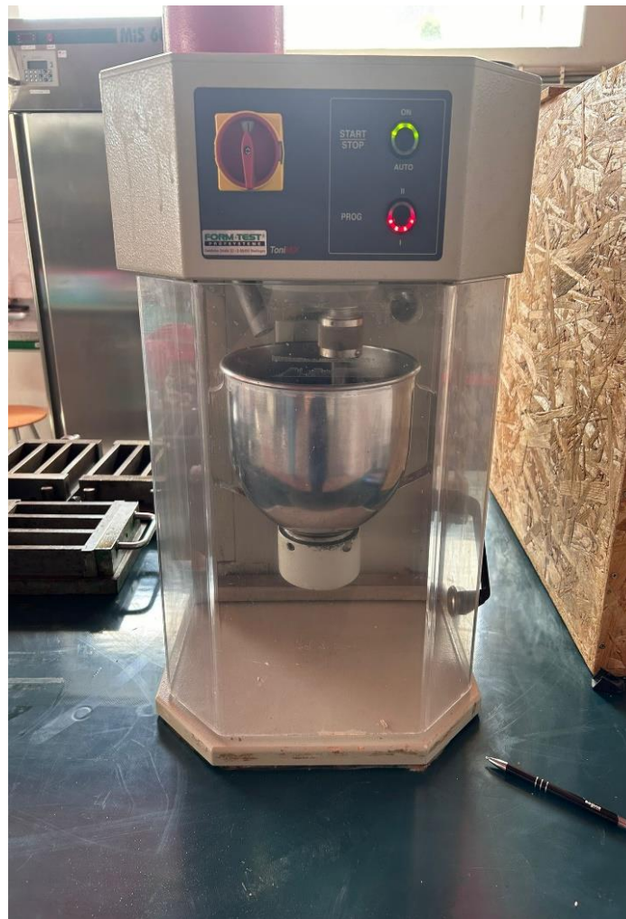
Slika 48. Miješalica za izradu mješavina morta
