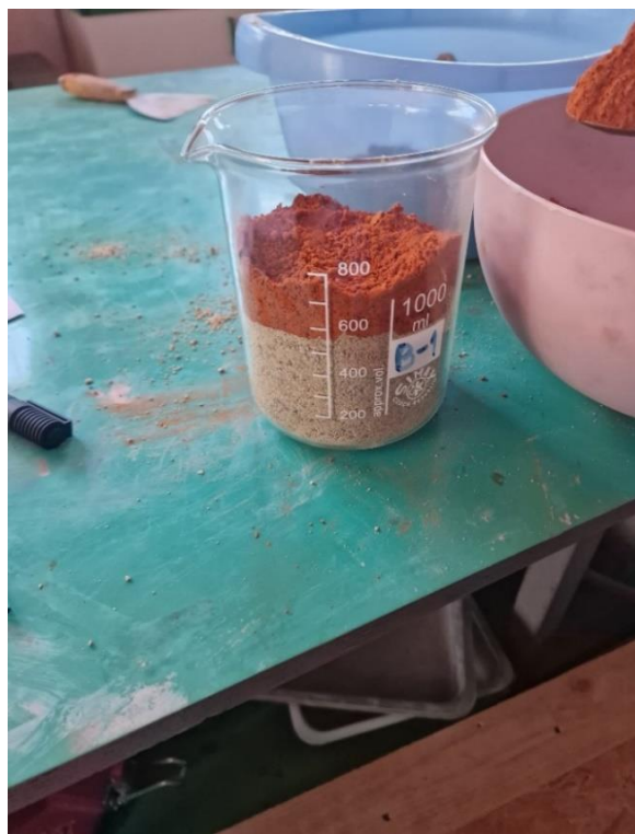
Slika 45. Prosijani agregat ( pijesak i drobljena opeka )
