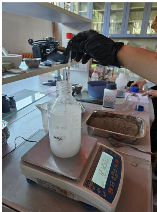
Slika 33. 10 molarna otopina i otopina vodenog stakla
