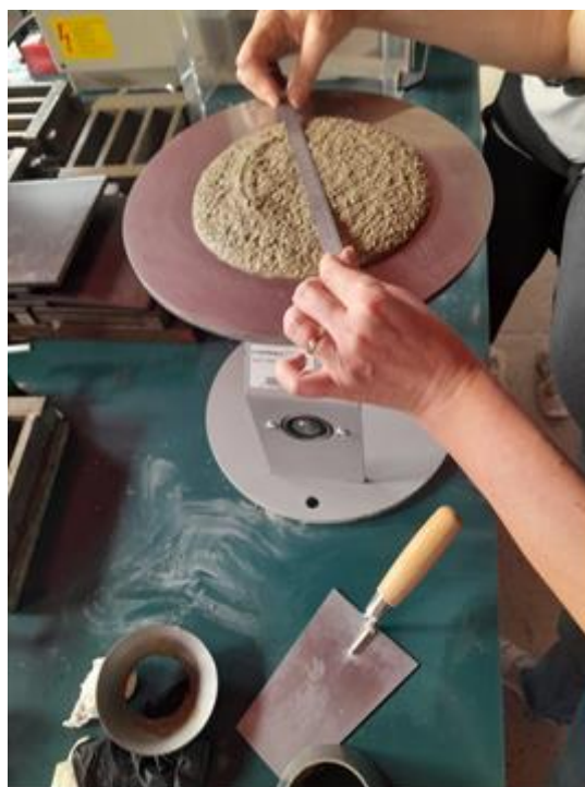
Slika 39. Određivanje konzistencije potresnim stolićem
