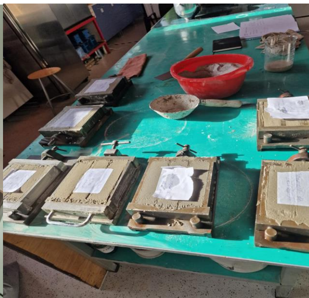
Slika 41. Mješavine morta ugrađene u kalupe
