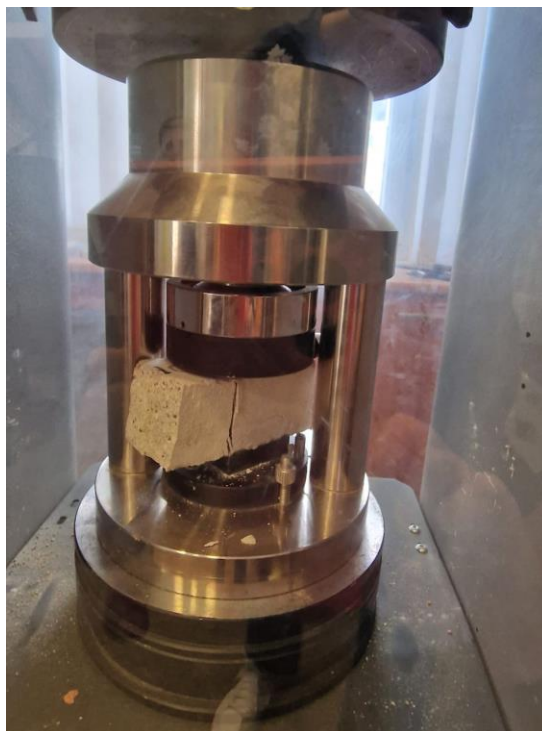
Slika 31. Određivanje tlačne čvrstoće prizmica sa kvarcnim pijeskom
