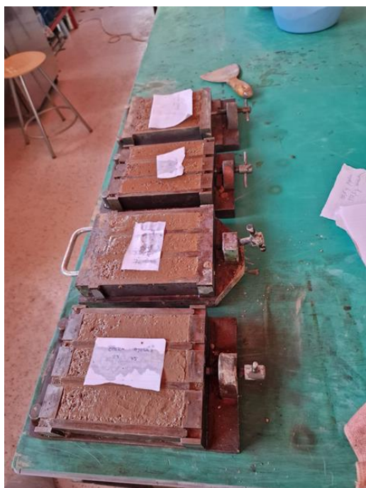
Slika 29. Mješavine ugrađene u kalupe
