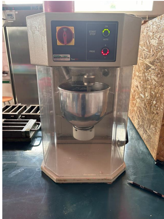
Slika 38. Miješalica za izradu mješavina morta
