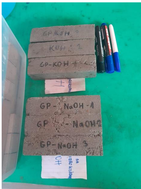
Slika 42. Prizmice geopolimernog morta
