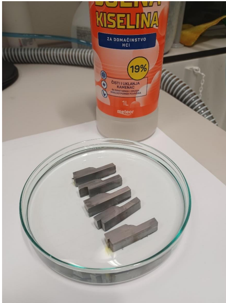
Slika 49. Uzorci uronjeni u kiselinu na početku [28]
