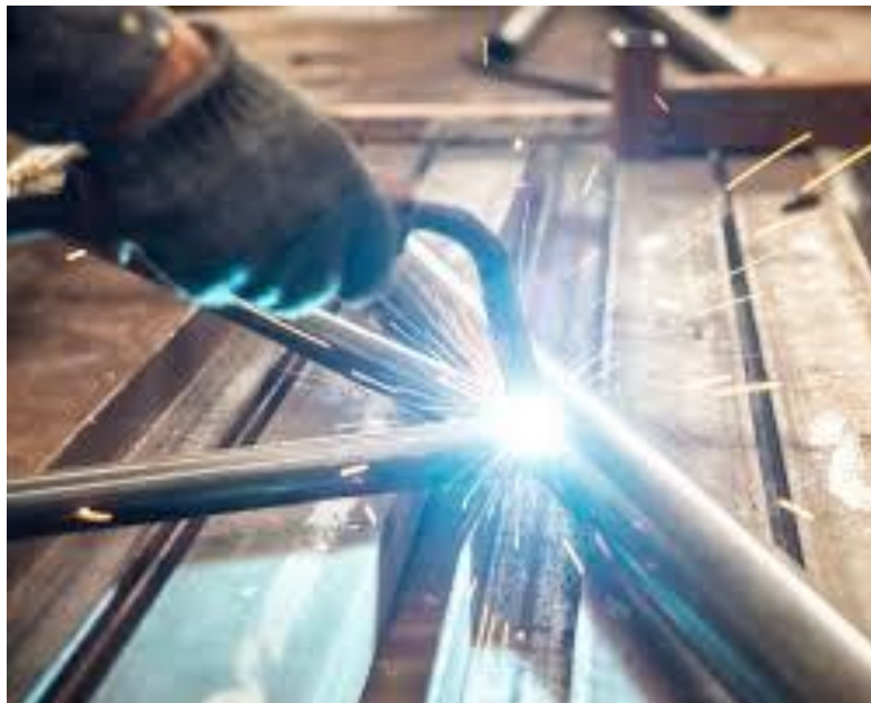
Slika 8. MIG/MAG zavarivanje cijevi od nehrđajućeg čelika [23]
