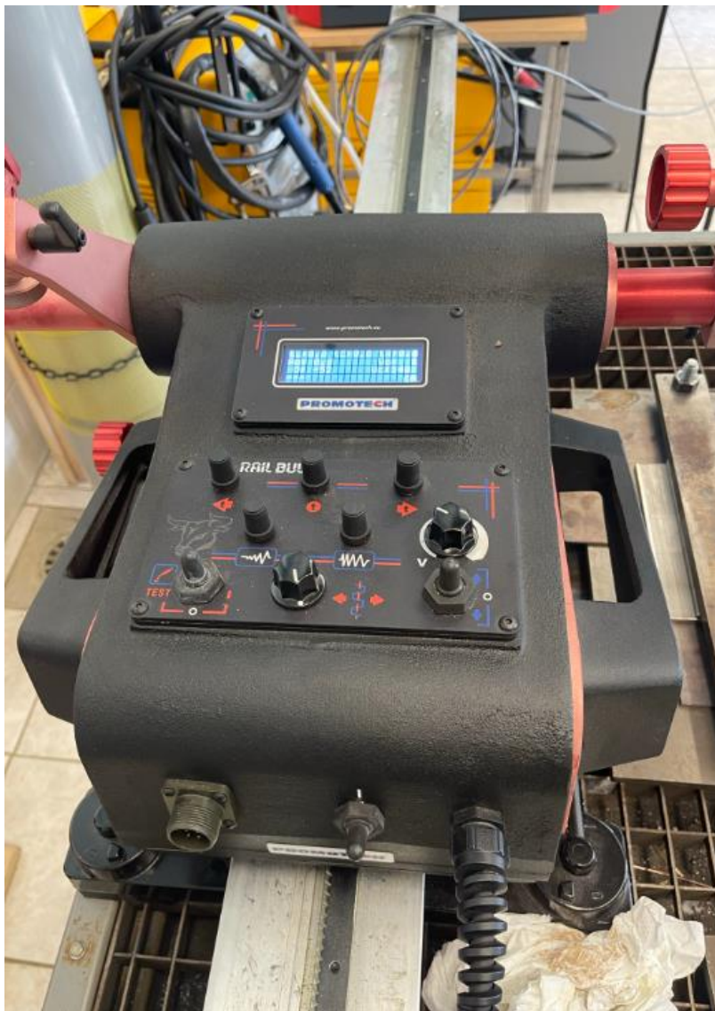
Slika 29. Uređaj za automatsko pravocrtno zavarivanje [28]
