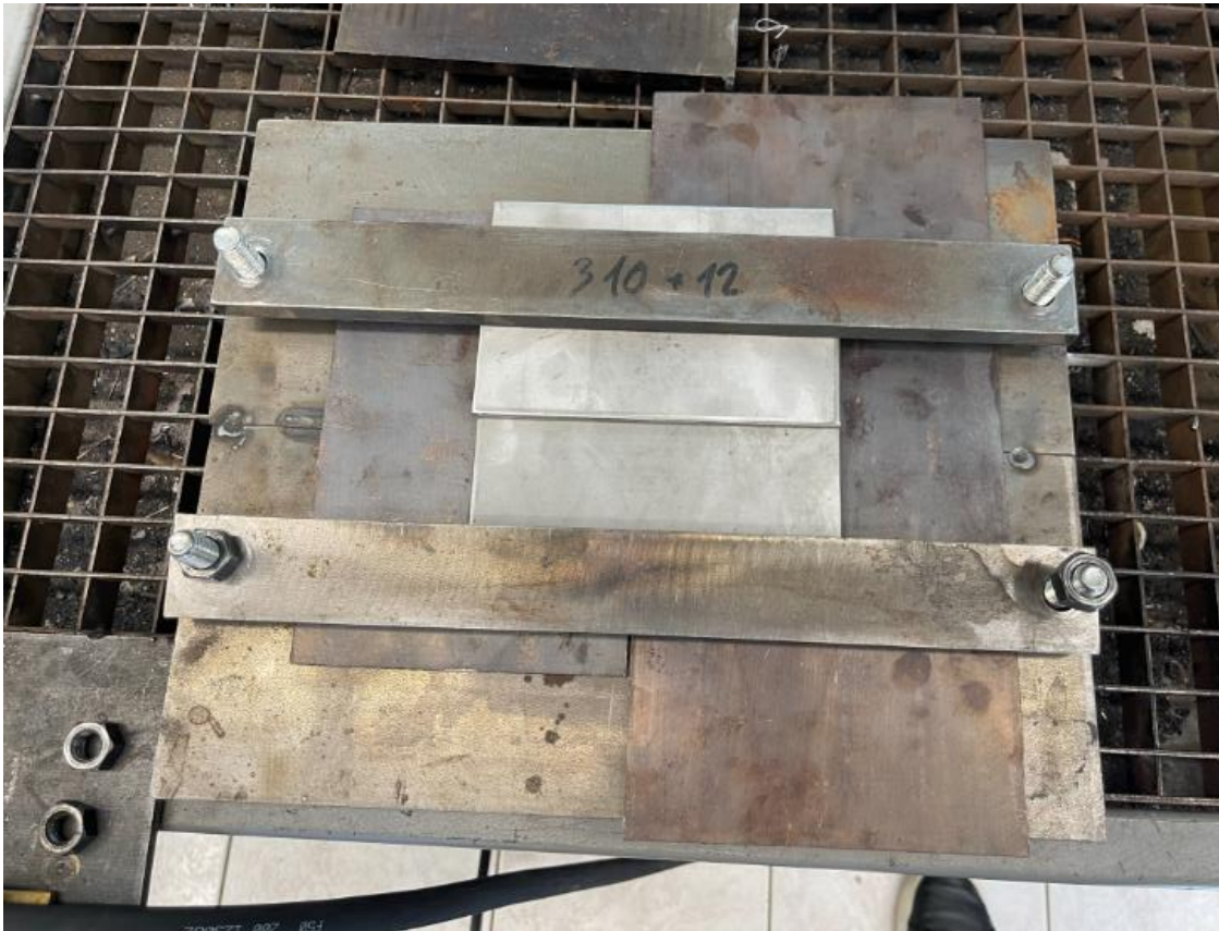
Slika 33. Prikaz pozicioniranog ispitnog uzorka spremnog za zavarivanje [28]
