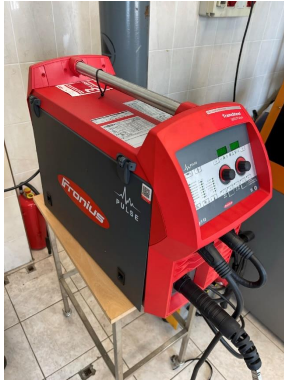
Slika 28. Uređaj za zavarivanje Fronius [28]
