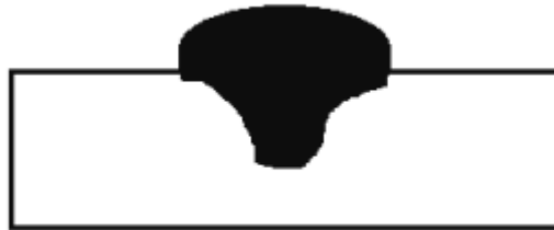
Slika 19. Utjecaj zaštitnog plina argona na geometriju zavora [14]
