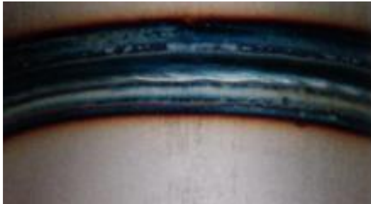
Slika 24. Oksidacija uz zavar [20]
