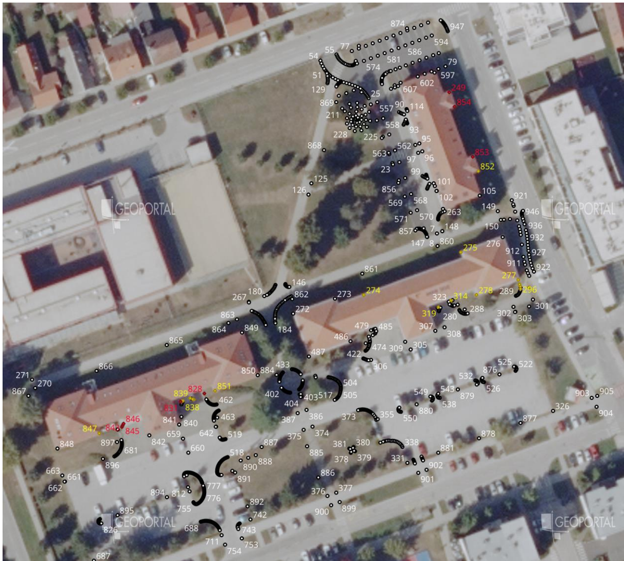
Slika 14 Preklap izmjerenih točaka s DOF-om u mjerilu 1:5000 preuzeto iz Geoportala 2023. godine (QGIS) [23]
