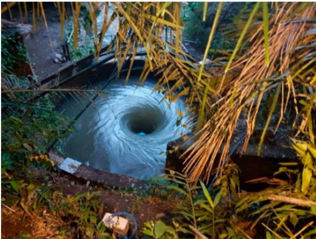
Slika 2.22 Prikaz rada Vortex turbine [11]
