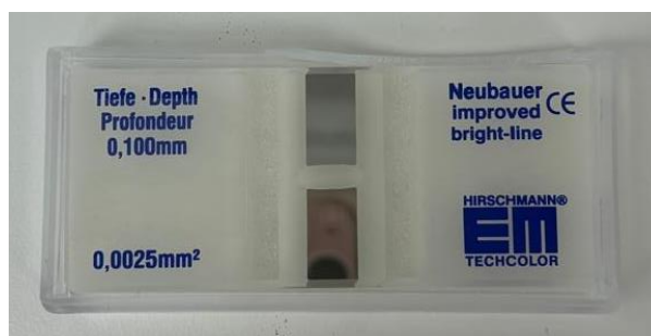
Slika 3.5.: Komora za brojanje spora Neubauer [vlastiti izvor]
