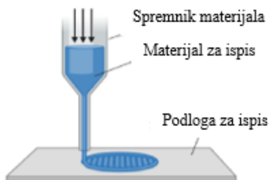
Slika 2.2. Prikaz tehnologije 3D ispisa na bazi ekstruzije [38]
