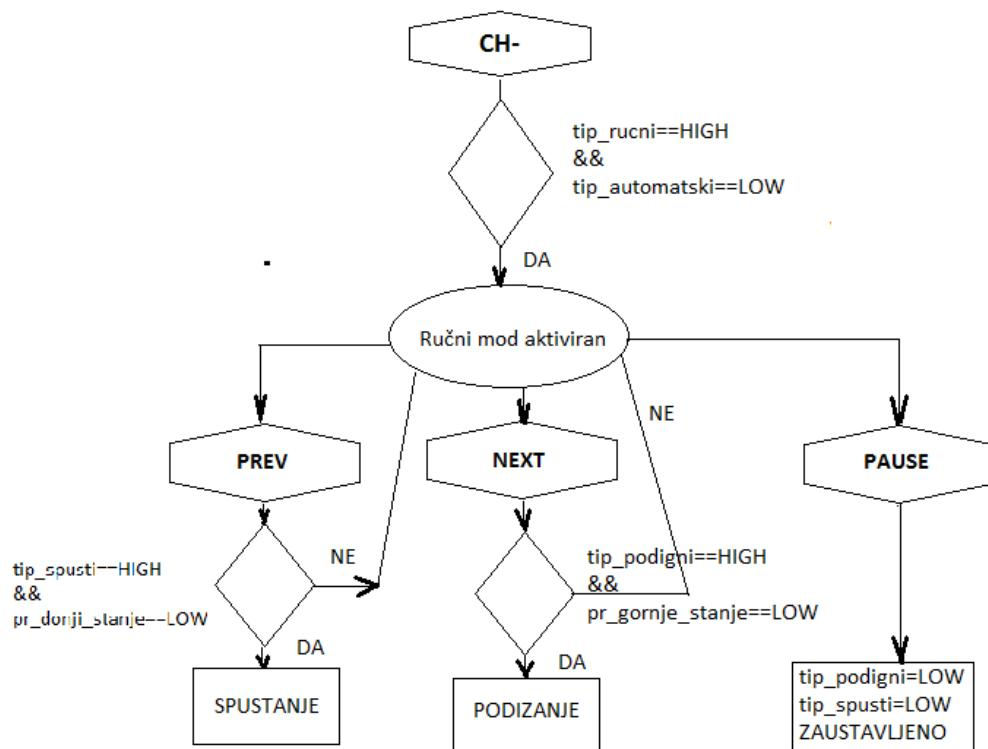
Slika 8.3 Blok dijagram ručnog moda rada
