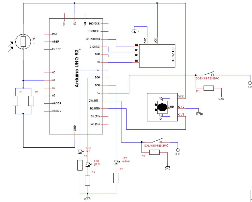
Slika 8.1 Shema tiskane pločice
