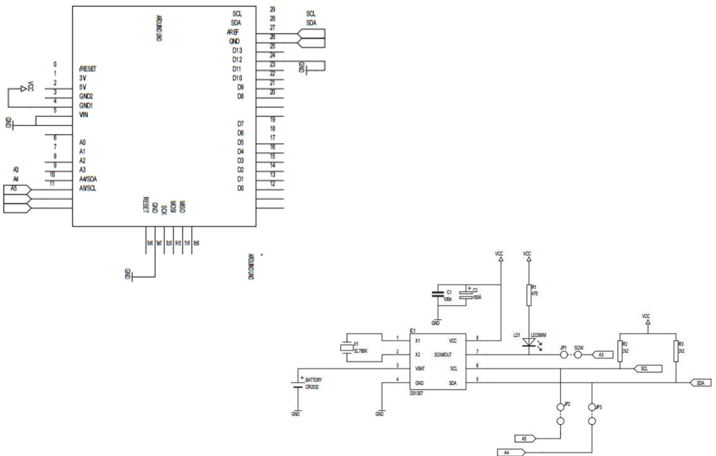
Slika 7.2 Način spajanja RTC na Arduino [18]
