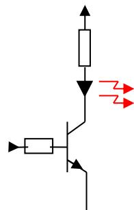
Slika 4.2 Tranzistorski sklop za pogon LED diode [12]
