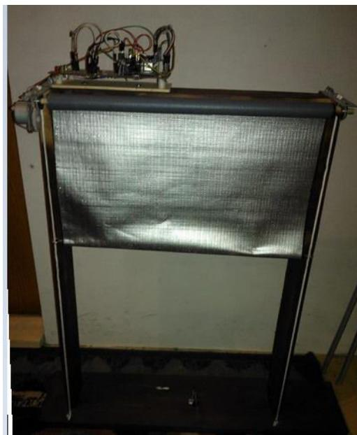
Slika 8.6 Prototip sustava za automatsko upravljanje roletom
