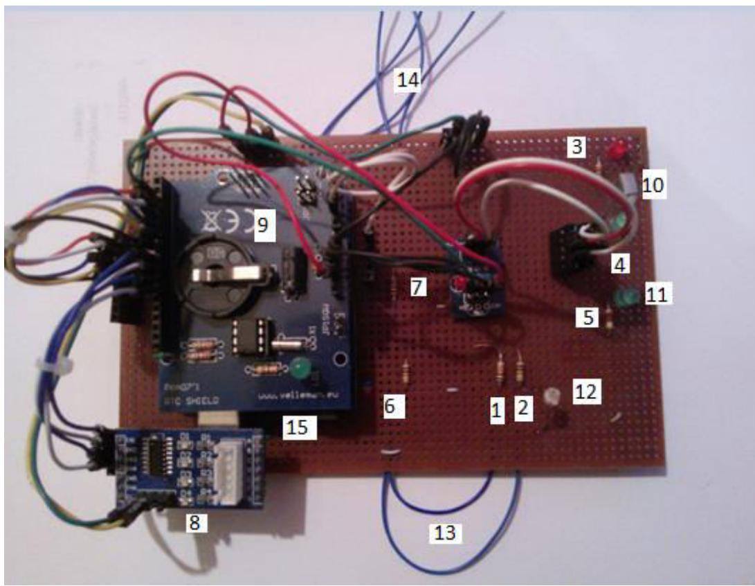
Slika 8.2 Tiskane pločice električkog dijela sustava upravljanja roletama
