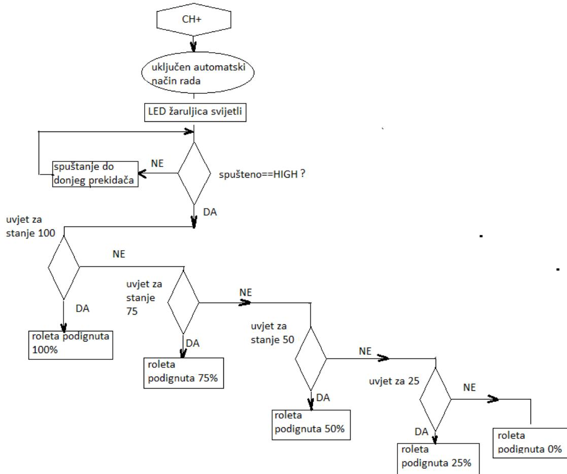
Slika 8.4 Automatski mod rada
