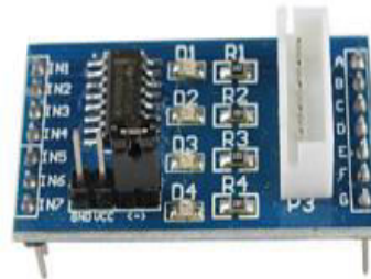
Slika 5.4 Pločica sa ULN2003 sklopom [17]
