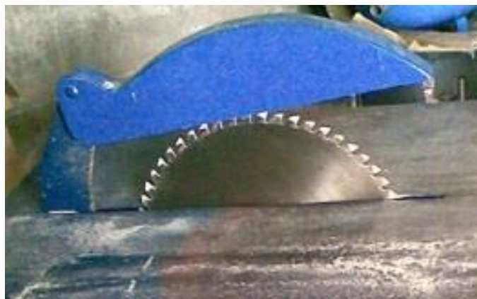
Slika 6.2: Razvodni klin i zaštitna kapa [2]
