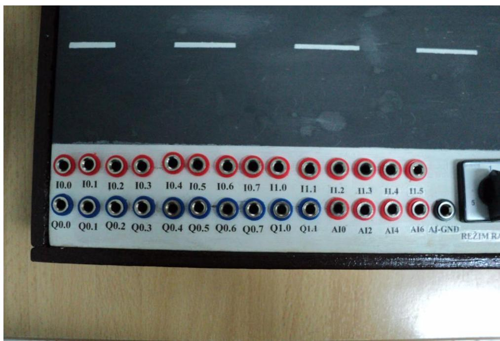
Slika 26. Izgled dijela za spajanje na PLC
