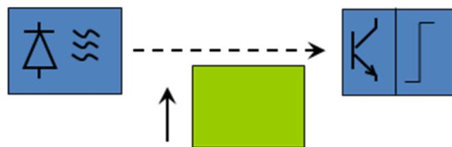
Slika 11. Prikaz optičkog senzora s odvojenim predajnikom i prijamnikom [9]
