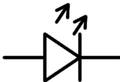
Slika 3. Simbol svjetleće diode [7]
