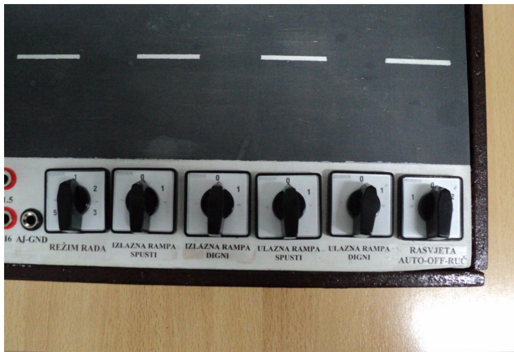
Slika 27. Izgled sklopki za ručno upravljanje i za rasvjetu
