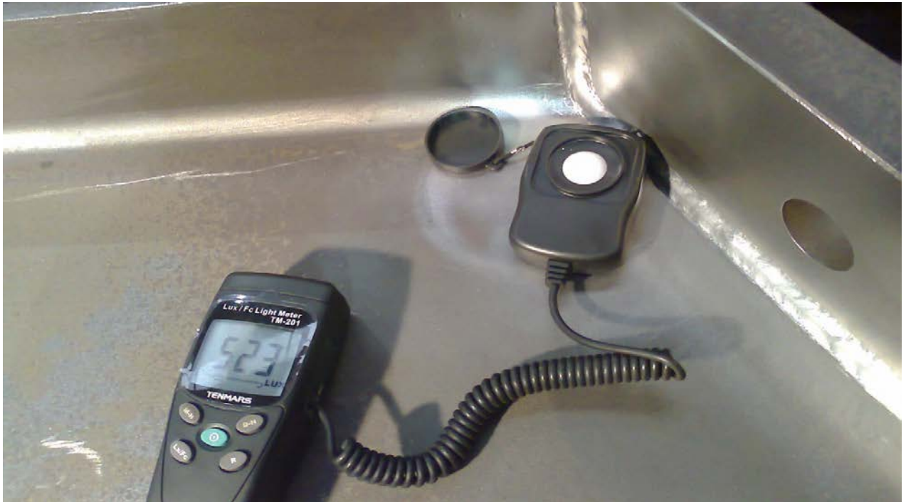
Slika 9. 23 Mjerenje jačine svijetla
