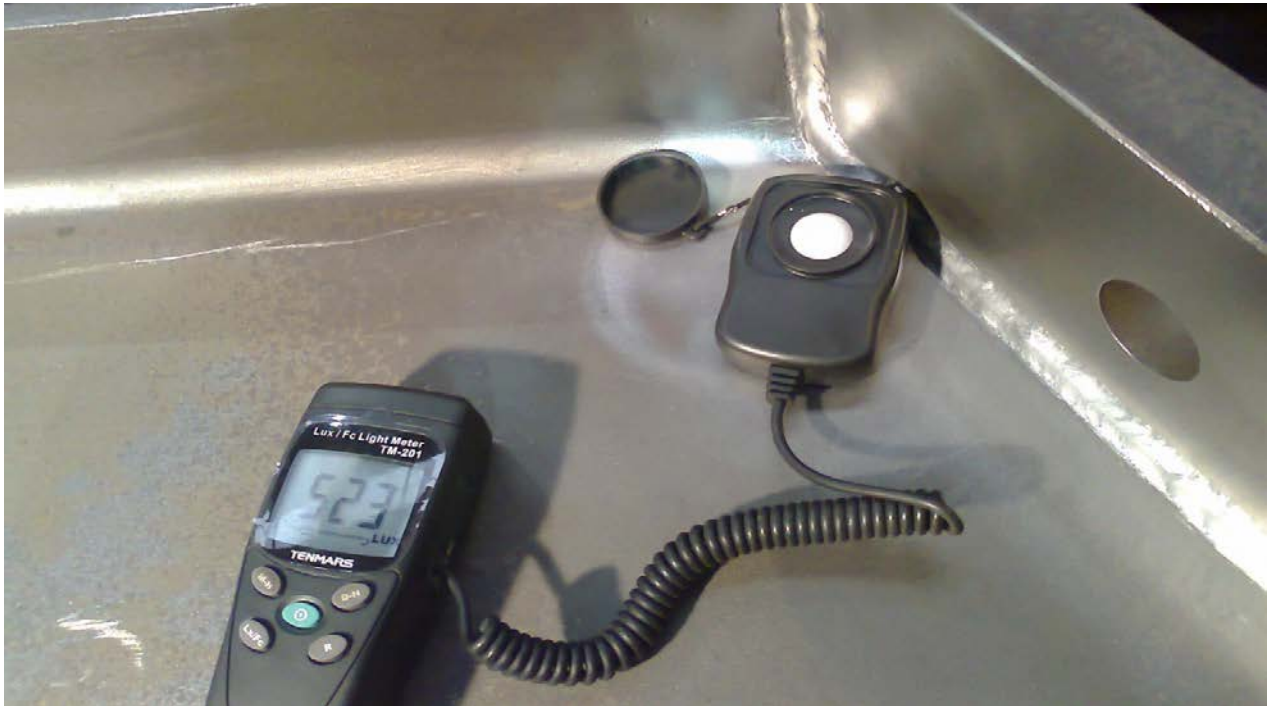
Slika 9. 23 Mjerenje jačine svijetla
