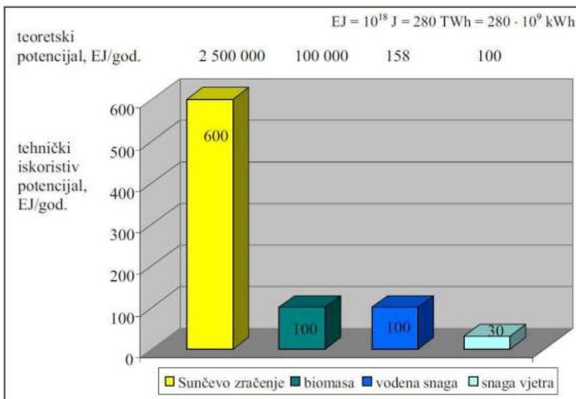
SLIKA 2.5. Teoretski i tehnički potencijal obnovljivih izvora energije [4]
