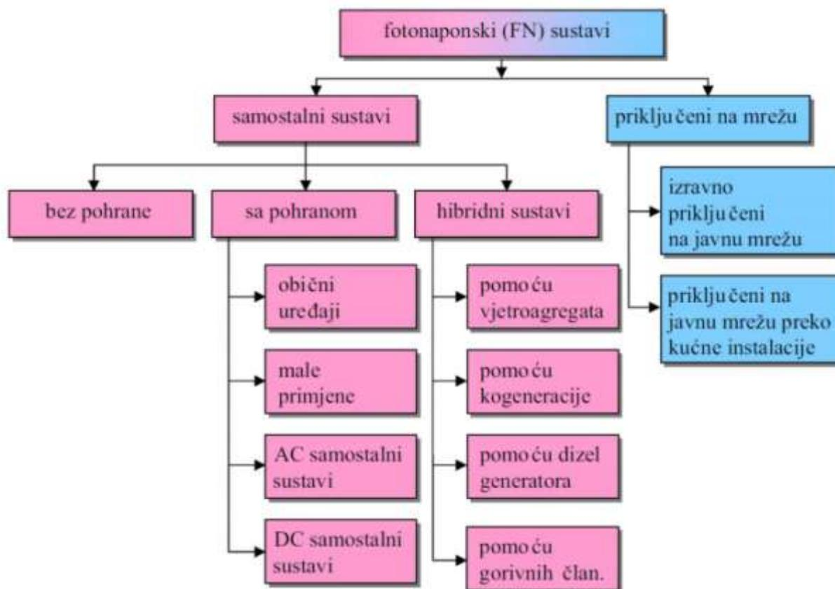
SLIKA 2.6. Osnovna podjela fotonaponskih sustava [4]
