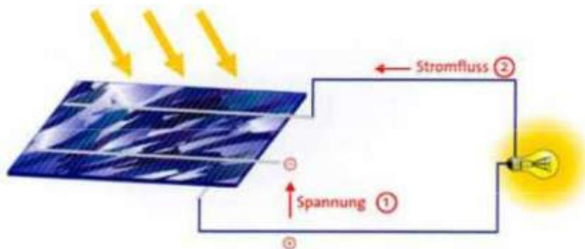
SLIKA 3.1. Solarna ćelija kao izvor električne energije [4]
