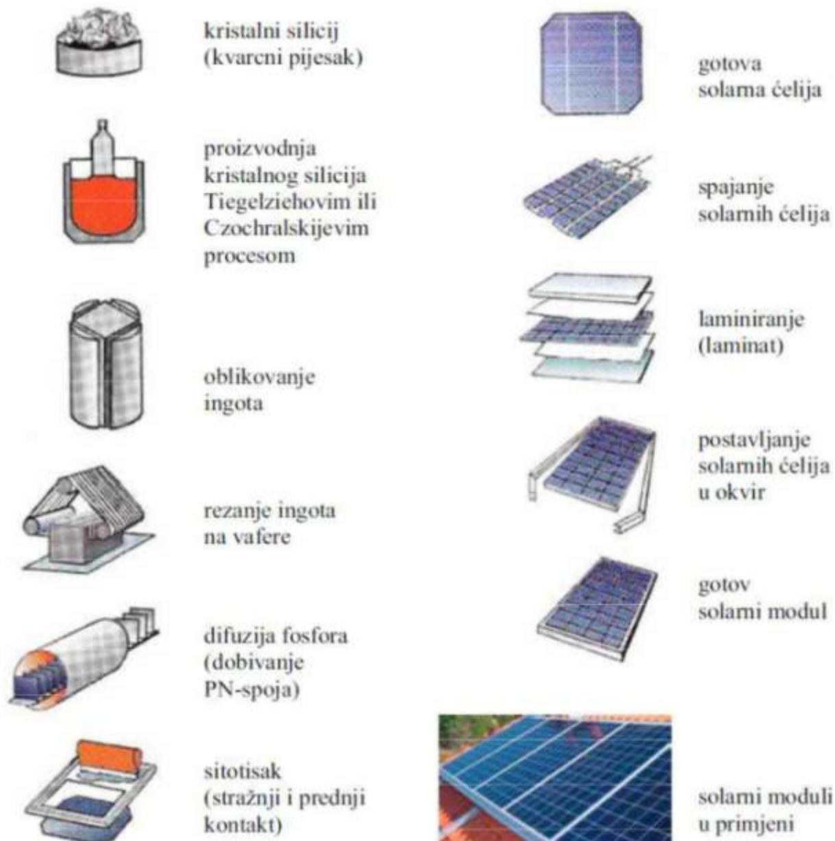
SLIKA 3.3. Postupak proizvodnje solarnih ćelija i FN modula [4]
