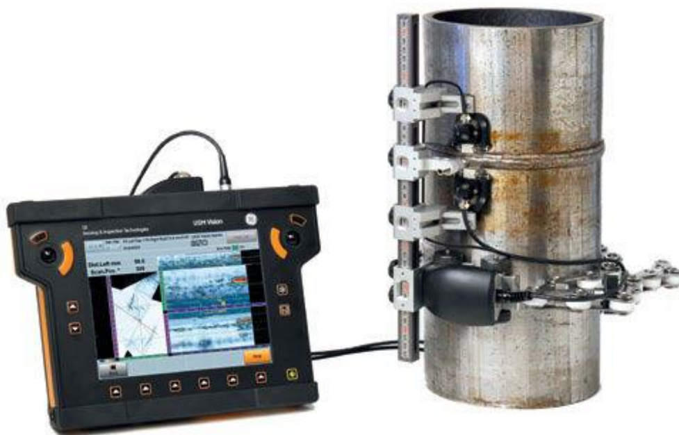
Slika 5.9 Uređaj za ultrazvučno ispitivanje [27]
