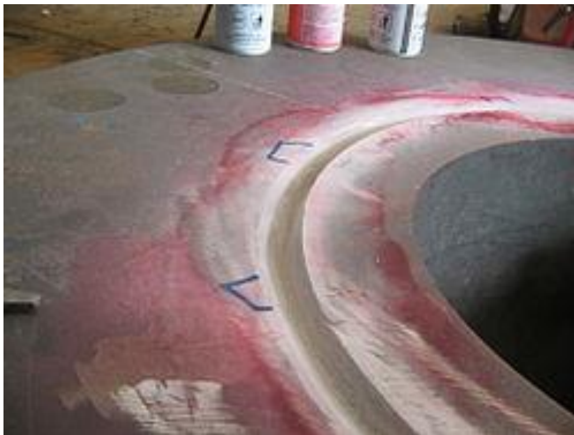
Slika 5.11 Izgled zavora kod penetrantskog ispitivanja [32]
