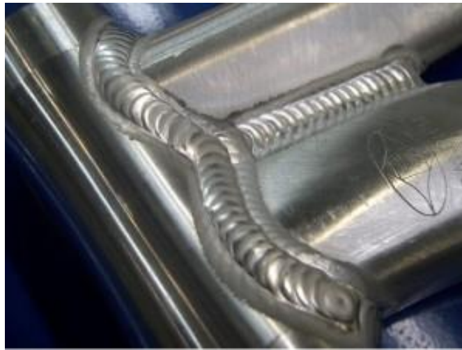
Slika 2.5 Zavareni spoj aluminija [9]
