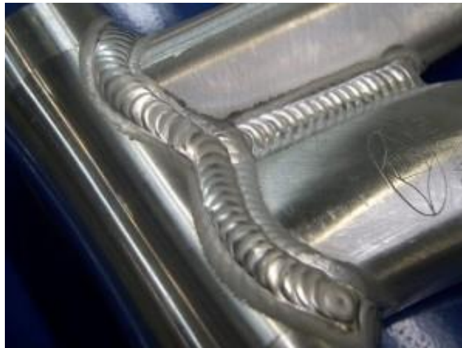
Slika 2.5 Zavareni spoj aluminija [9]
