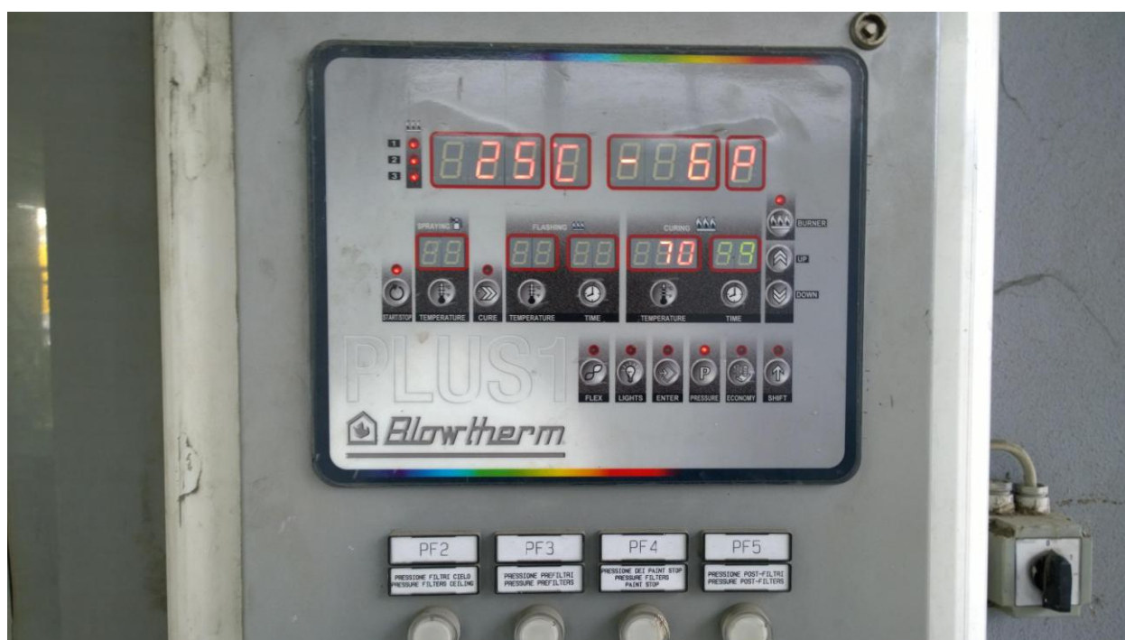
Slika 6.13 Postavljanje temperature za sušenje
