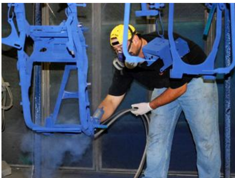
Slika 5.14 Postupak plastificiranja metala [50]
