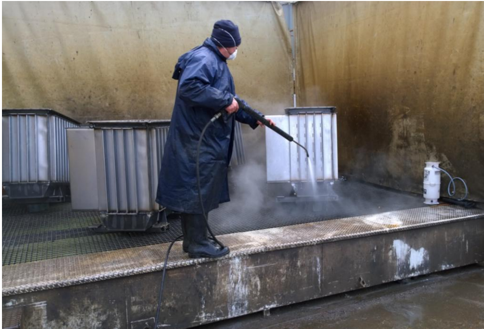
Slika 5.4 Odmašćivanje visokotlačnim prskanjem
