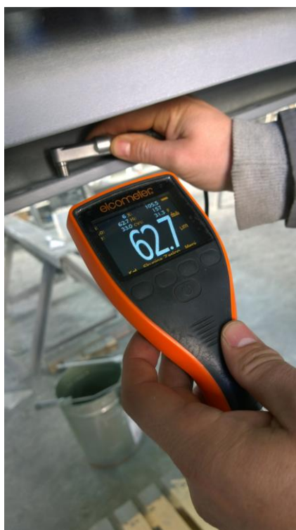
Slika 6.10 Mjerenje debljine suhog filma
