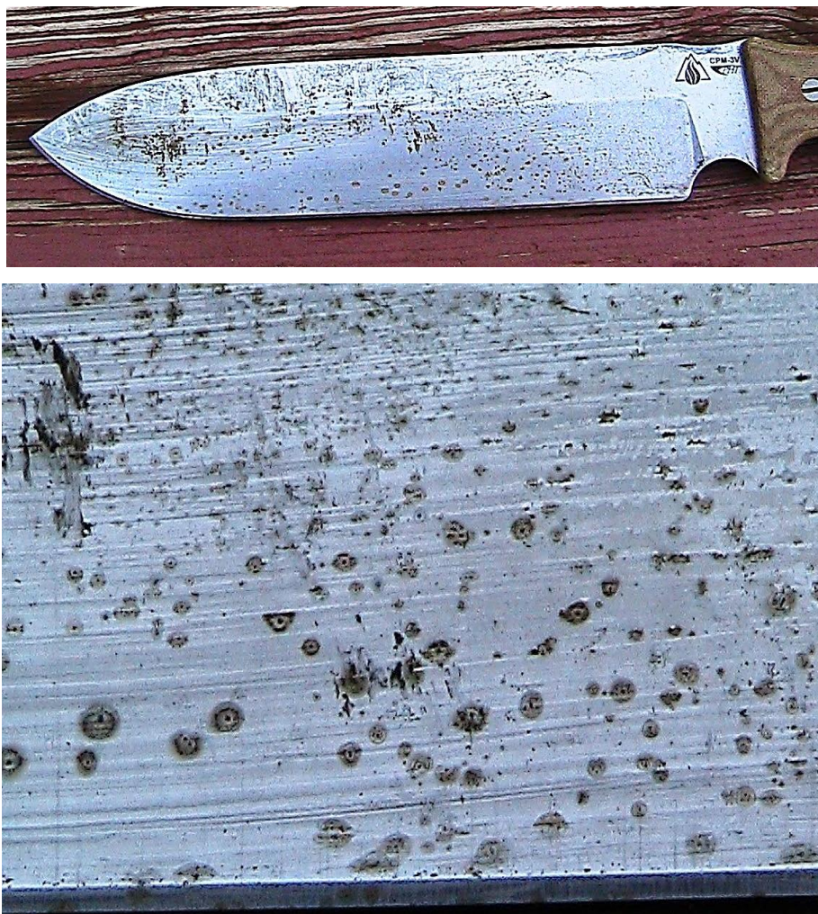
Slika 4.12 Primjer pjegaste korozije na oštrici noža [23]
