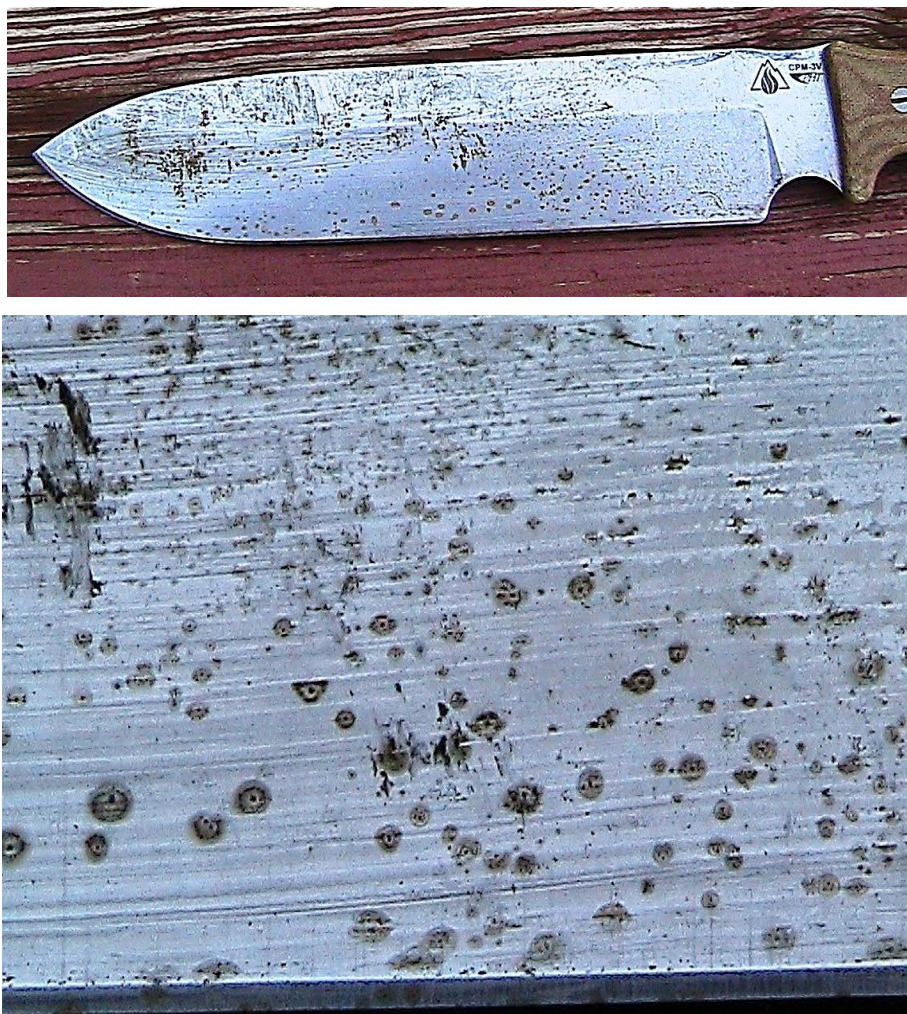
Slika 4.12 Primjer pjegaste korozije na oštrici noža [23]
