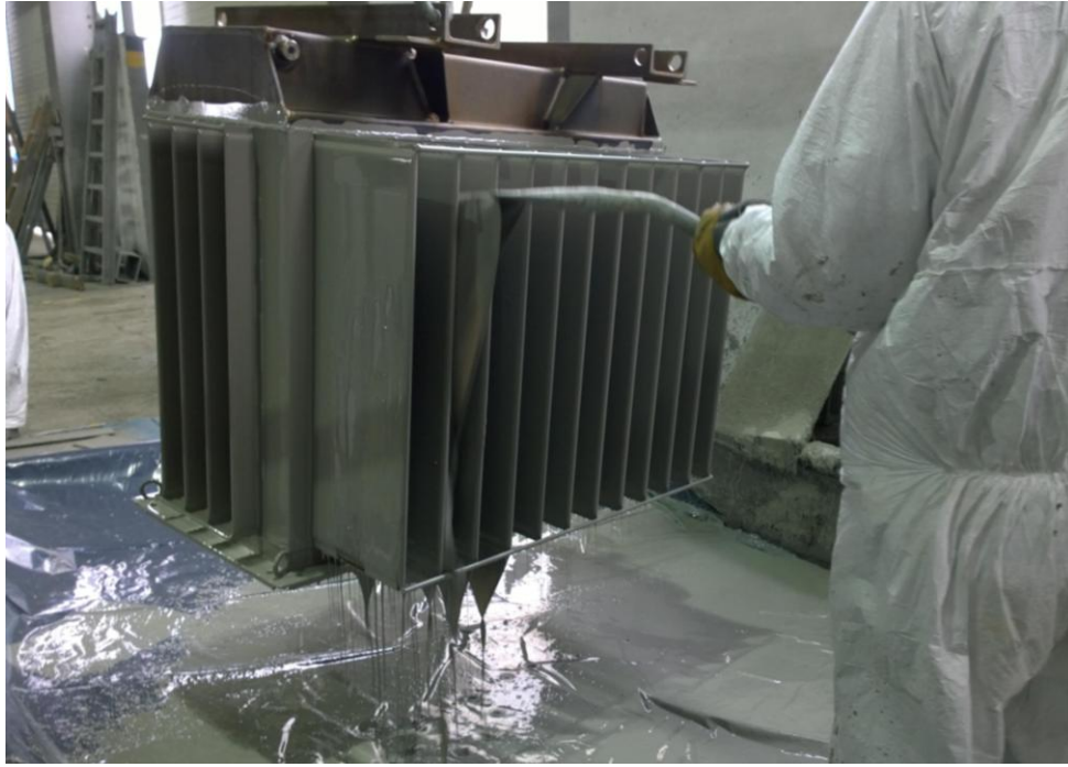
Slika 5.20 Nanošenje boje prelijevanjem
