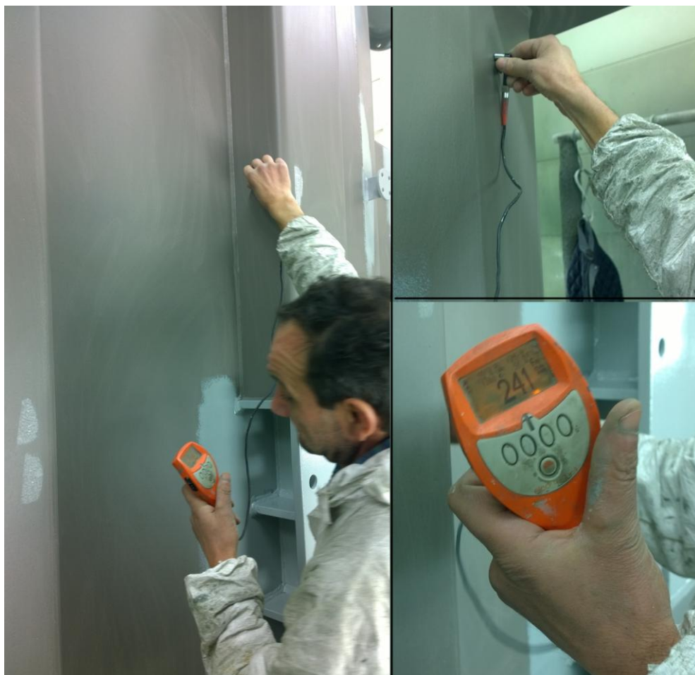
Slika 6.19 Kontrola debljine prethodno nanesenih sloja prije lakiranja
