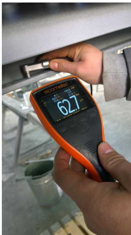
Slika 6.10 Mjerenje debljine suhog filma
